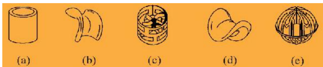
Figura 10.1. Empaques para columnas: (a) Anillo Raschig. (b) Silleta Intalox (c) Anillo Pall. (d) Silleta Berl. (e) Anillo Hy-Pak (Castro y colaboradores, 2010).
