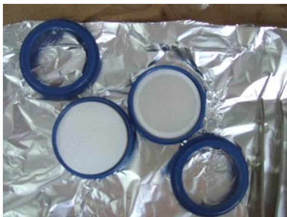
Figura 2.2. Filtros de teflón y portafiltros para muestreador Mini-vol (JAMSTEC, 2007).
