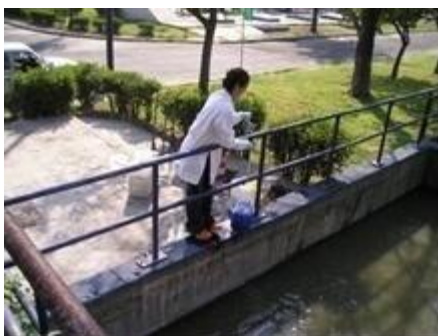
Figura 1.3. Muestreo desde un puente (Inst. de Ingeniería-UNAM, 2006)
