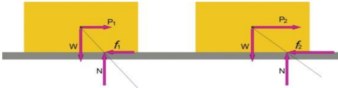
Figura 34. Distribución de las fuerza según cómo va actuando la fuerza de fricción.
