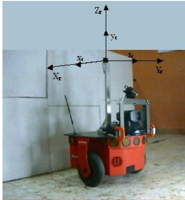
Figura 2.4. Geometría del sistema de navegación.
