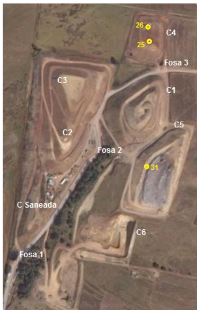
Figura 2.1 Pozos de venteo muestreados (color amarillo) y lagunas o fosas de lixiviados 2 y 3 del RESA de San Luis Mextepec, Zinacantepec, Edo. de México.
