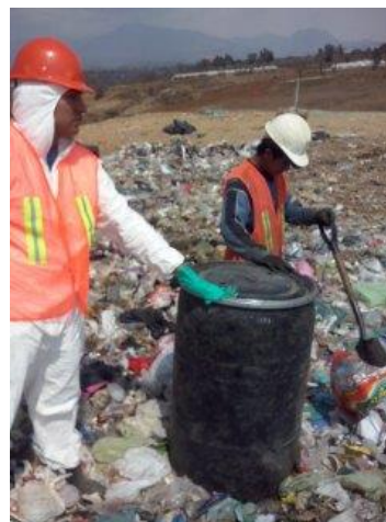
Figura 1.4 Tambo para peso volumétrico y traslado de RSU.
