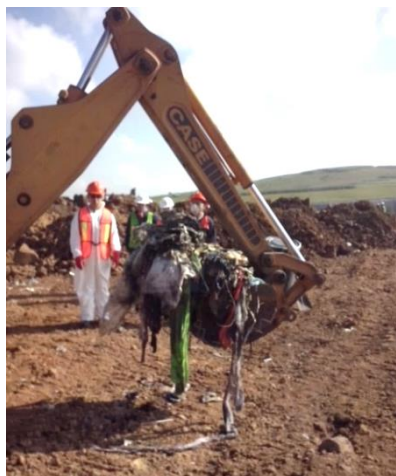
Figura 1.3 Muestreo con garra mecánica de RSU.
