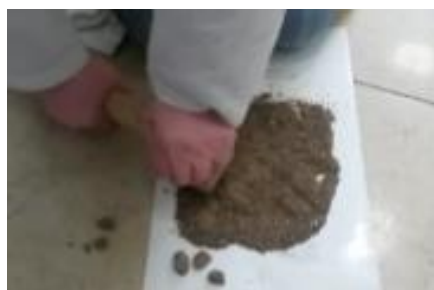
Figura 1.6 Disgregación de suelo
