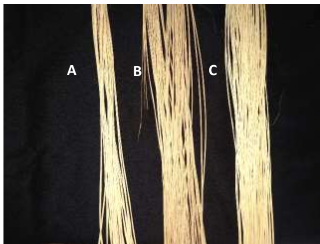
Figura 3.17. Efecto del percarbonato al 10% por 45 min en: A) fibra secada al sol, B) fibra con tratamiento hidrotérmico y C) fibra artesanal blanqueada con azufre.
