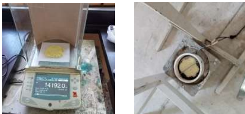
Figura 3.13. Pesado y colocación de azufre en la placa de calentamiento
