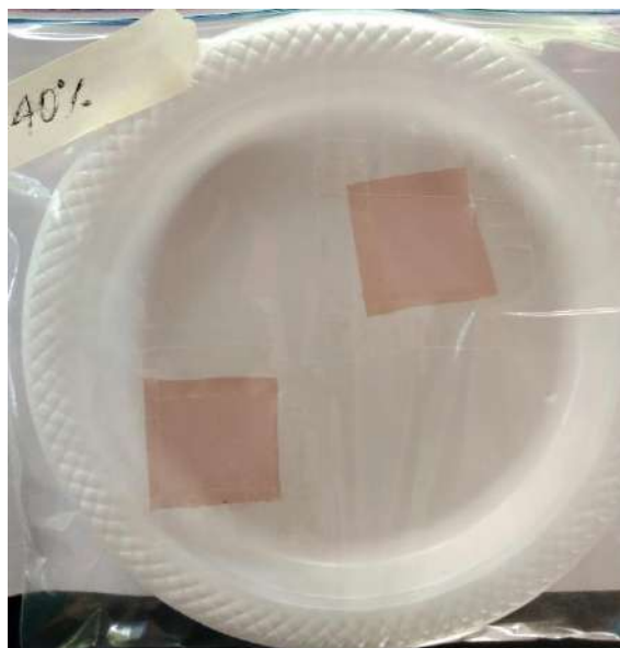
Figura 2.2 Contenedor con película indicadora de pH al 40 % de extracto de caimito para bioensayo con carne de pechuga de pollo.
