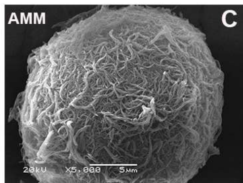
Figura 3.3 Micrografías electrónicas de barrido de A) Almidón nativo de maíz. C) Almidón modificado de maíz. Tamaño de partícula de B) ANM D) AMM
