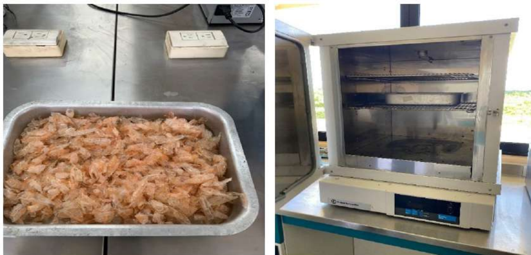
Figura 2.13 Proceso de secado de las cascaras de camarón
