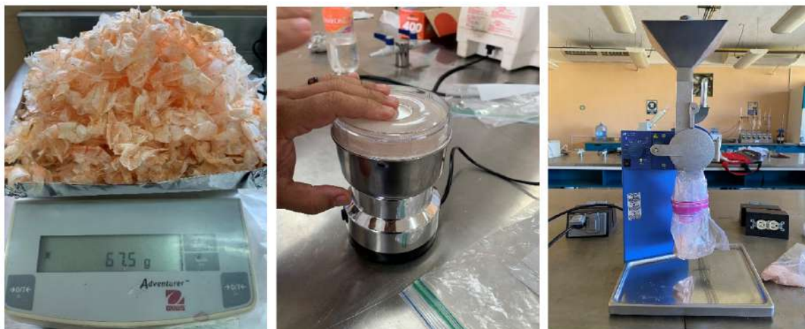
Figura 2.14 Proceso de triturado de las cascaras de camarón.
