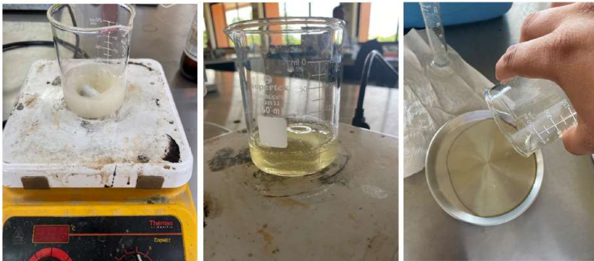
Figura 2.23 Proceso de elaboración de las películas de quitosano.
