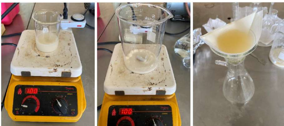
Figura 2.21 Proceso de desacetilación con carbonato de sodio.
