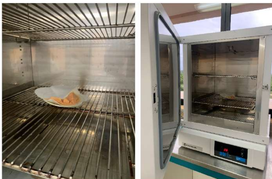
Figura 2.17 Proceso de secado de las muestras ya desmineralizadas.
