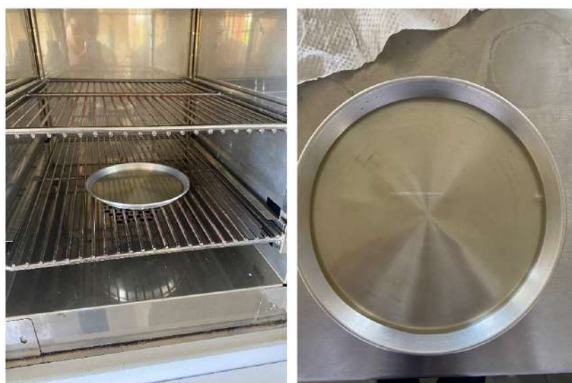
Figura 2.24 Secado de las películas de quitosano.
