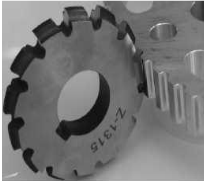
Figura 2.9. Tallado de un engranaje con fresa de módulo.
