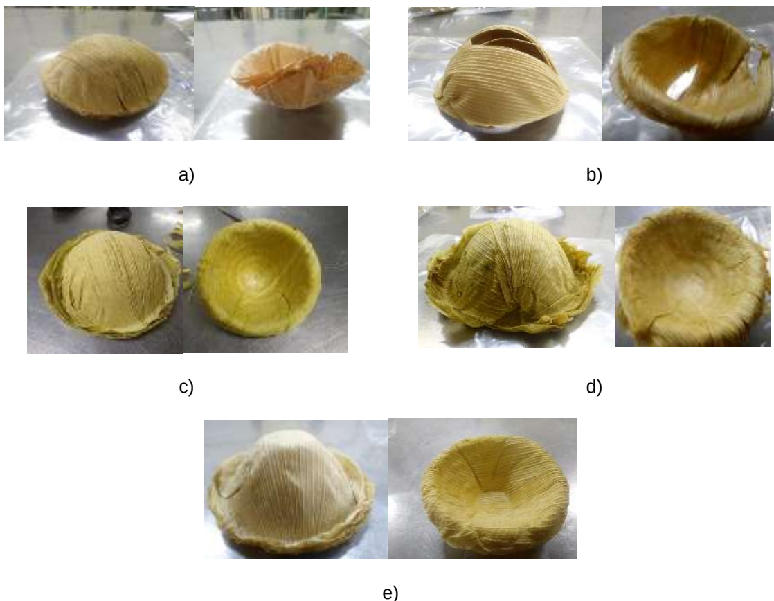
Figura 19. Productos obtenidos de las pruebas preliminares; a) Prueba 1 hoja seca, b) Prueba 2 hoja seca, c) Prueba 3 hoja fresca, d) Prueba 4 hoja fresca, e) Prueba 5 hoja fresca.
