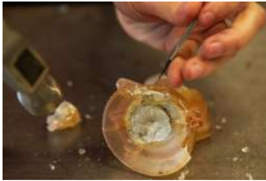
Figura 7. Ejemplo de molde Sacrificable (formlabs, s.f.).
