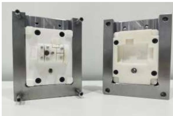
Figura 8. Ejemplo de molde reutilizable (formlabs, s.f.).
