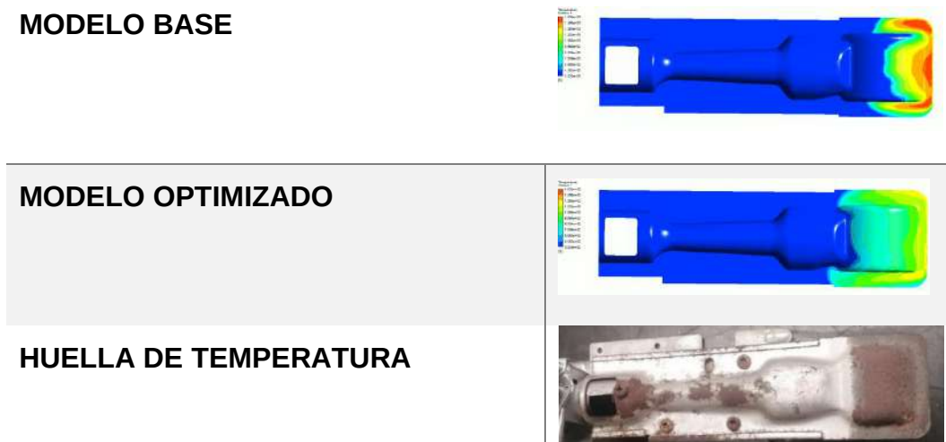
Figura 4.20. Comparación de distribución de temperaturas entre el modelo base, modelo optimizado y las huellas de corrosión de un quemador.
