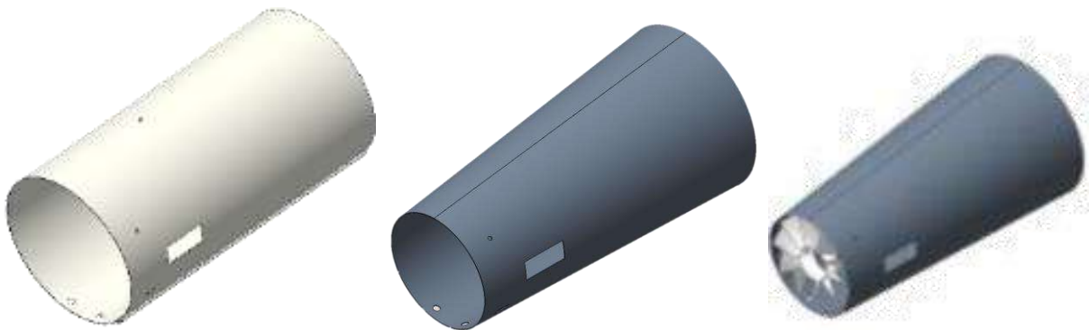
Figura 3.8. Cámaras de combustión línea base, cónica y cónica con arremolinador
