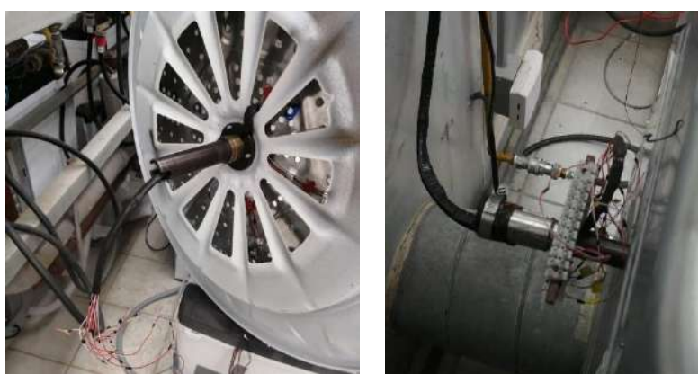
Figura 3.39. eje instalado en difusor de la cámara de secado y dispositivo de pistas rotativo
