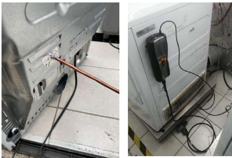
Figura 3.41. instalación de tubo colector de gases de combustión e instrumentación
