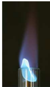
Figura 2.14. Retroceso de flama [25]
