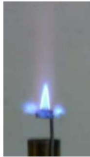
Figura 2.13. Separación de flama [25]
