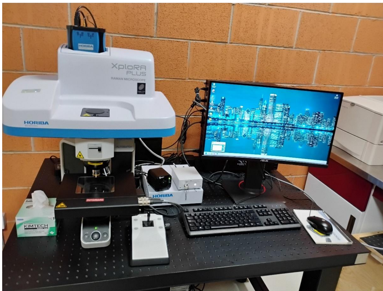
Figura 4.1 Espectrómetro Raman utilizado para la caracterización de sustancias en sustratos nanoestructurados. Fuente propia. (2025).
