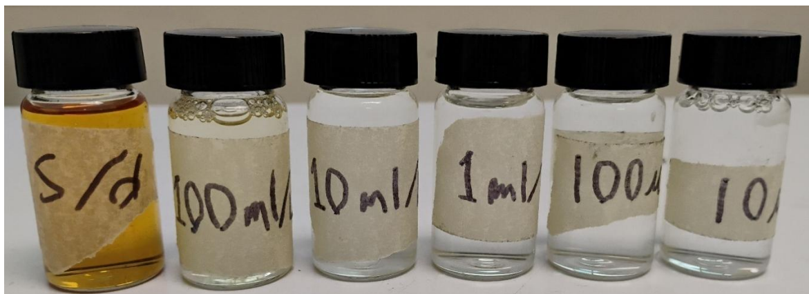
Figura 3.9 Se diluyó glifosato en distintas concentraciones donde se probaron los sustratos nanoestructurados. Fuente propia. (2024).
