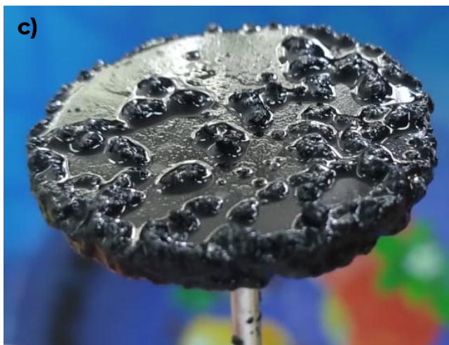
Figura 4.1 Películas a 5 V, 40 mA y 20 min a) PPy, b) PPy/SDS y c) PPy/SDS/NTCs.
