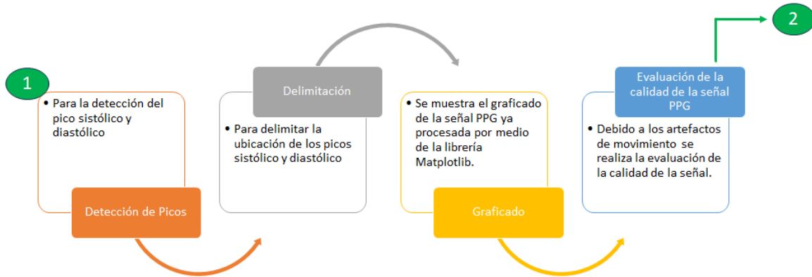
Figura 3.26 Diagrama de flujo del código para el procesamiento y extracción de características de la señal PPG 2/4.
