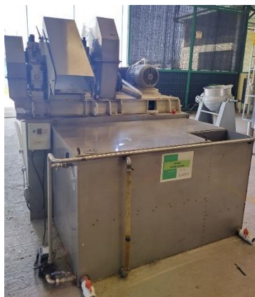
Figura 2.2 Molino marca TILCA para la obtención de bagazo de caña
