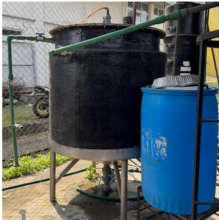
Figura 2.2. Reactor de hidrólisis escala piloto de la Planta de Aprovechamiento de Residuos del Instituto Tecnológico de Orizaba.
