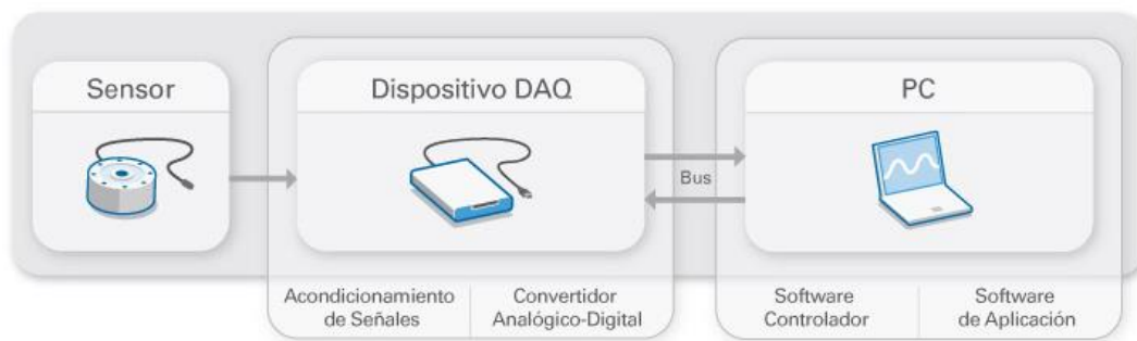
Figura 1.15 Partes de un sistema de Adquisición de datos (DAQ)
