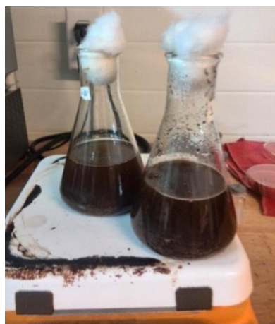
Figura 2.8 Extracción de compuestos fenólicos por lixiviación
