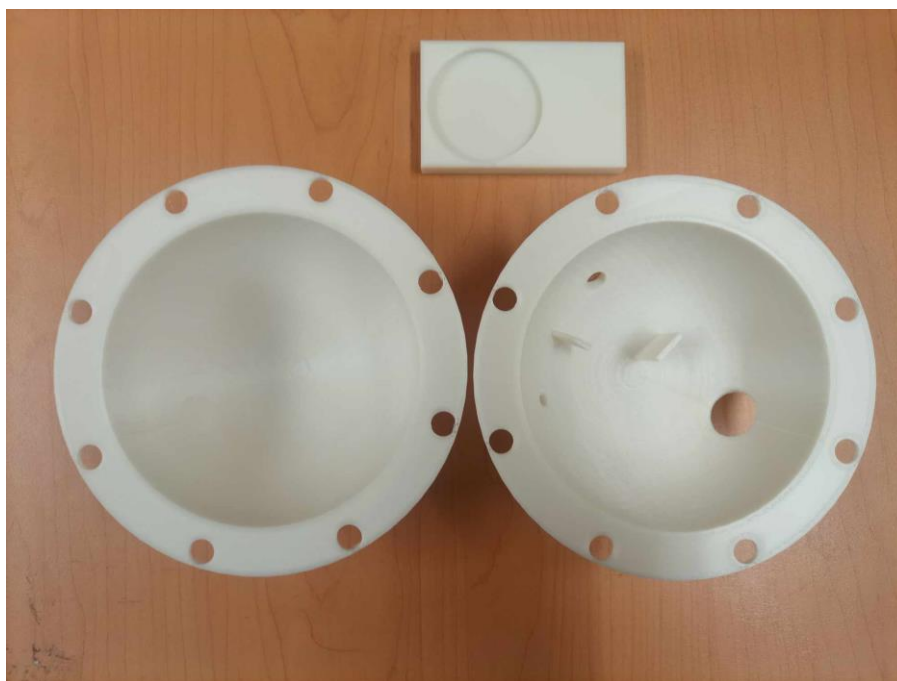
Figura 6.1. Impresión 3D de la esfera integradora para mediciones in vivo .
