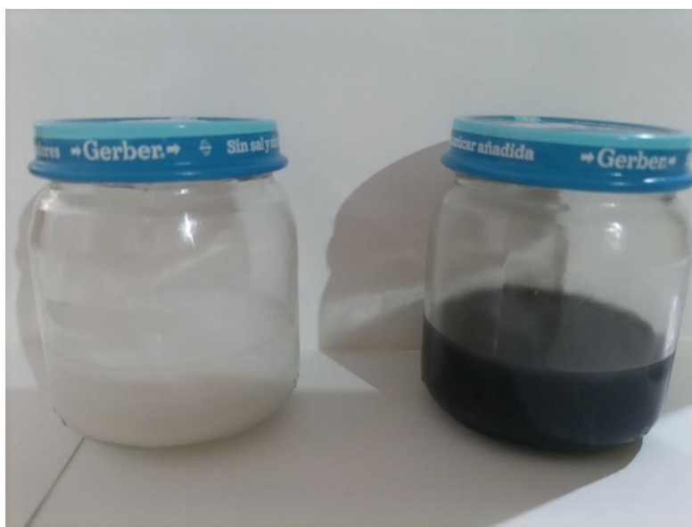
Figura 4.19. Dilución de pigmento blanco y negro en parte A de silicón.
