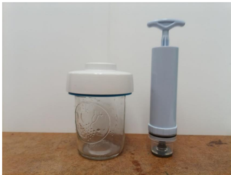
Figura 4.18. Sistema para desgasificar la mezcla de silicón.
