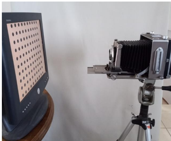
Figura 3.10. Montaje para grabado de película.
