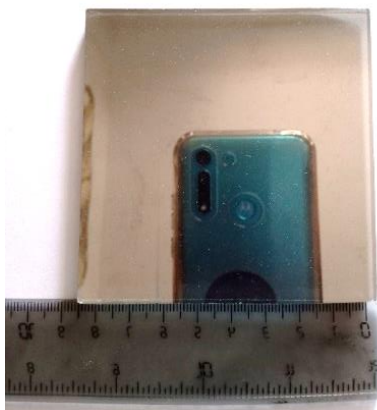
Figura 3.12. Placa de vidrio como divisor de haz.
