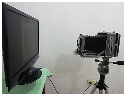
Figura 2.26. Montaje para grabado de película.
