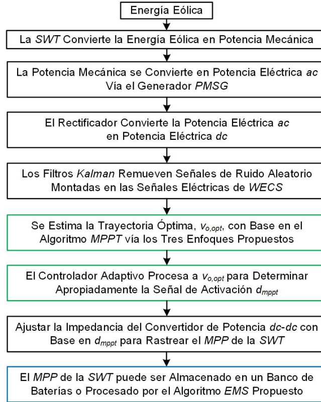
Fig. 5.7 Proceso MPPT para alcanzar el máximo punto de potencia de la SWT.
