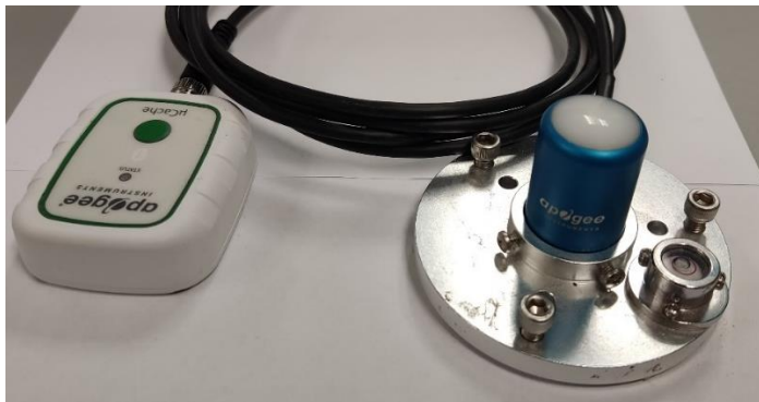
Figura 6.9 Sensor cuántico y datalogger marca Apogee.
