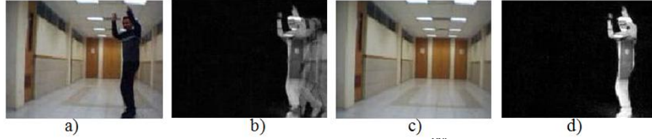
Figura 3.9. Procesamiento de DR-SOM en video ‘Vi1’. a) I(x,y,z)^{130} . b) I_d(x,y)^t . c) I_b(x,y,z)^t después de la ecuación 3.25. d) I_e(x,y)^t .
