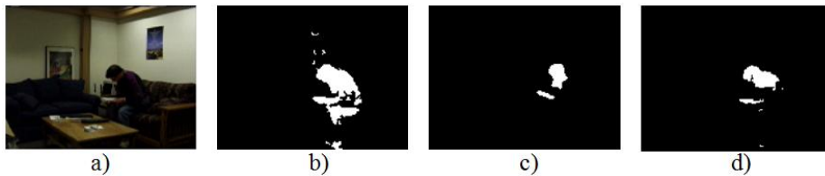
Figura 3.37. Resultados de segmentación de objetos en condiciones de oscuridad y cambios de iluminación gradual. a) Video ‘TD’, t=1851 . b) I_s(x,y)^t con SOM-CNN. c) Resultados de segmentación con CNN. d) Resultados de segmentación con SSOM.
