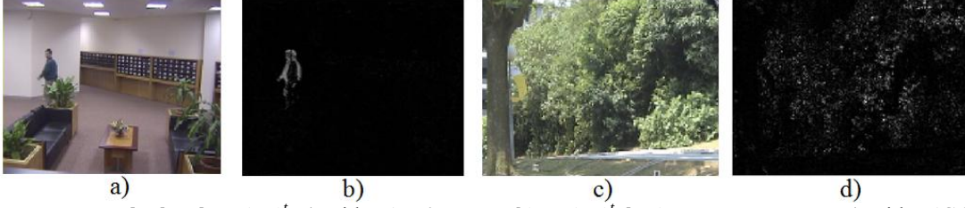
Figura 3.21. Resultados de Iv(x,y)^t . a) Video 'LB', t=380 . b). Iv(x,y)^t de a). con \mu_v=0.00991 . c) Video 'CAM', t=580 . d). Iv(x,y)^t de c). con \mu_v=0.0235 .
