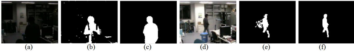
Figura 3.31. Segmentación de objetos dinámicos en cambios de iluminación. a) Video ‘CM’ t=1050 . b) I_s(x,y)^t . c) Ground truth. d) Video ‘CM’ t=1140 . e) I_s(x,y)^t . f) Ground truth.
