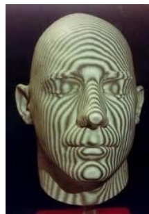
Figura 1.2 Patrón moiré proyectado sobre objeto.
