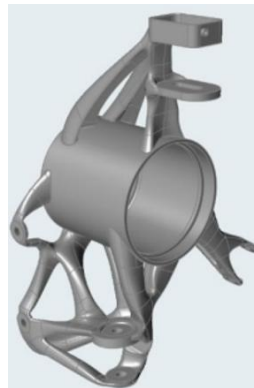
Figura 1. 14. Modelo final de la mangueta trasera, combinando los tres casos de cargas [22].
