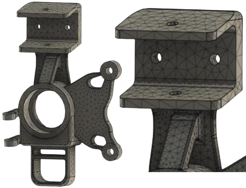
Figura 5. 14. Geometría optimizada reportada en la literatura con un mallado tetraédrico [26].
