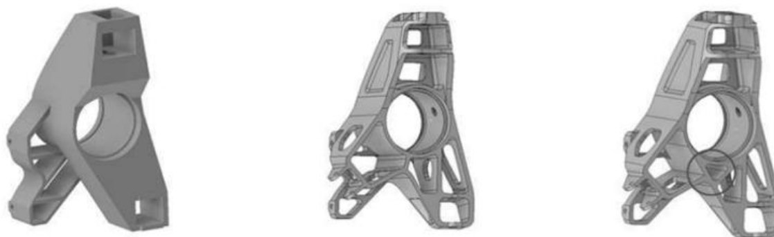
Figura 1. 3. Comparativo de la mangueta de referencia (izquierda), mangueta optimizada enfocada a la reducción de masa (centro) y a mejorar la rigidez (derecha) [7]
