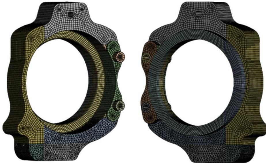
Figura 7. 19. Mallado predominantemente hexaédrico de la mangueta optimizada con enfoque en la minimización de esfuerzos para el vehículo FSAE eléctrico.
