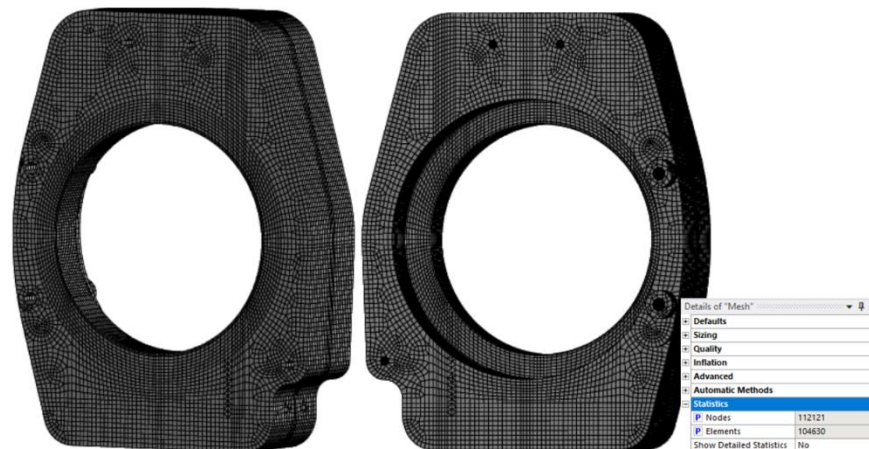
Figura 7. 8. Mallado hexaédrico refinado en la mangueta de referencia para el vehículo FSAE eléctrico con transmisión tipo IWM.
