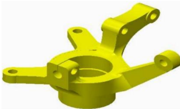
Figura 1. 7. Mangueta fabricada con hierro fundido gris de Fórmula estudiantil [13].
