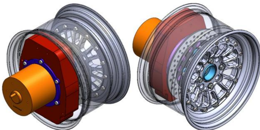
Figura 7. 3. Ensamblaje del sistema de transmisión IWM con la mangueta de referencia propuesta (en rojo) y el rin.
