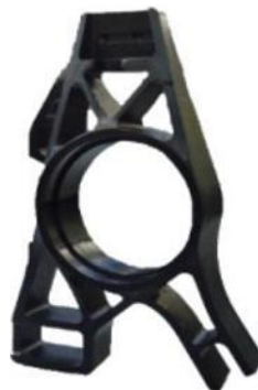
Figura 1. 6. Mangueta trasera de un vehículo de Fórmula estudiantil [12]
