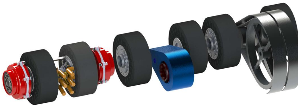
Figura 1.3. Diferentes conceptos de transmisión, de izquierda a derecha: engranajes planetarios, etapa de engranes rectos y correa dentada [9].
