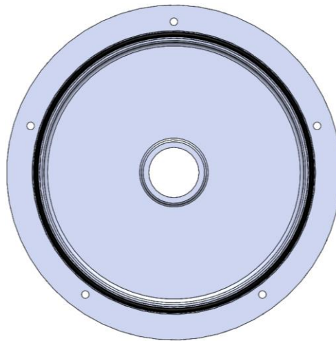
Figura 8.16. Ubicación del sello tipo O-Ring en la tapa frontal de la carcasa.
