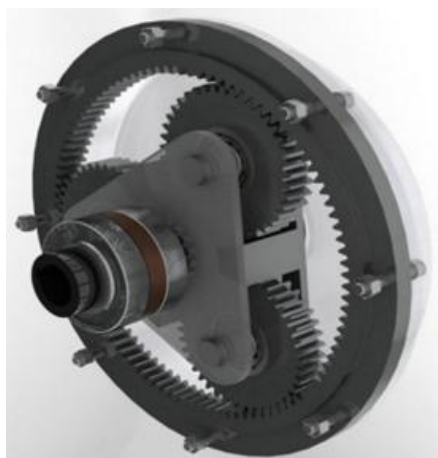
Figura 1.5. Modelo CAD 3D del tren de engranes diseñado por Bakshi et al. [10].
