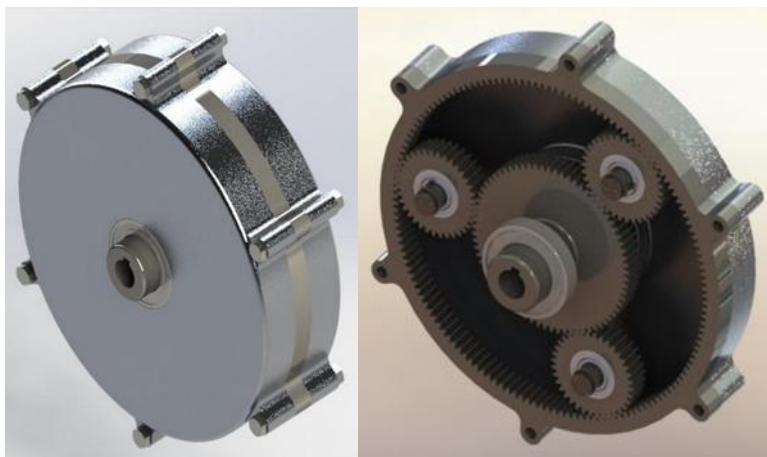
Figura 1.11. Modelo geométrico CAD 3D del ensamblado final de la caja de engranajes con carcasa (izquierda) y su interior sin porta-satélites (derecha) propuesto por Patel et al. [16].
