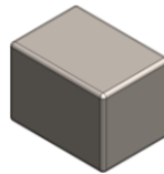
Figura 8.3. Modelo CAD 3D de la cuña utilizada en el eje de entrada del sistema de transmisión.
