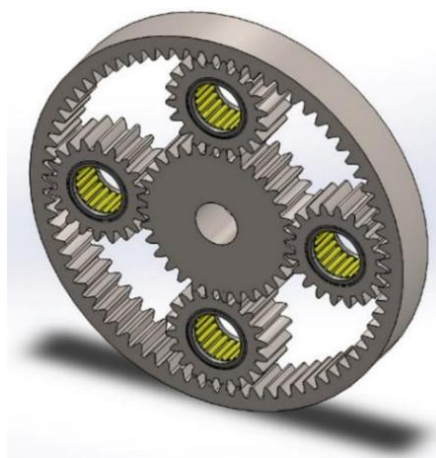
Figura 1.13. Tren de engranajes planetarios diseñado por Rohithraj y Arun Sundar [18].
