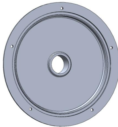
Figura 8.12. Modelo geométrico CAD 3D de la tapa frontal de la carcasa: vista posterior.
