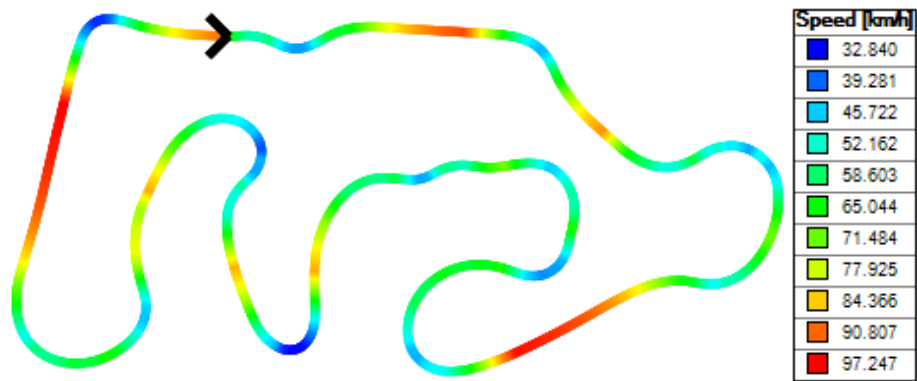
Figura 9.17. Velocidades del vehículo FSAE eléctrico equipado con el sistema de transmisión IWM propuesto en el circuito FSAE Endurance Germany 2010.
