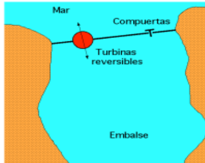
Figura 10 Embalse con turbinas de doble efecto [25].
