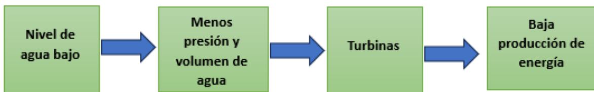
Figura 5 Diagrama de bloques nivel de agua mínimo.
