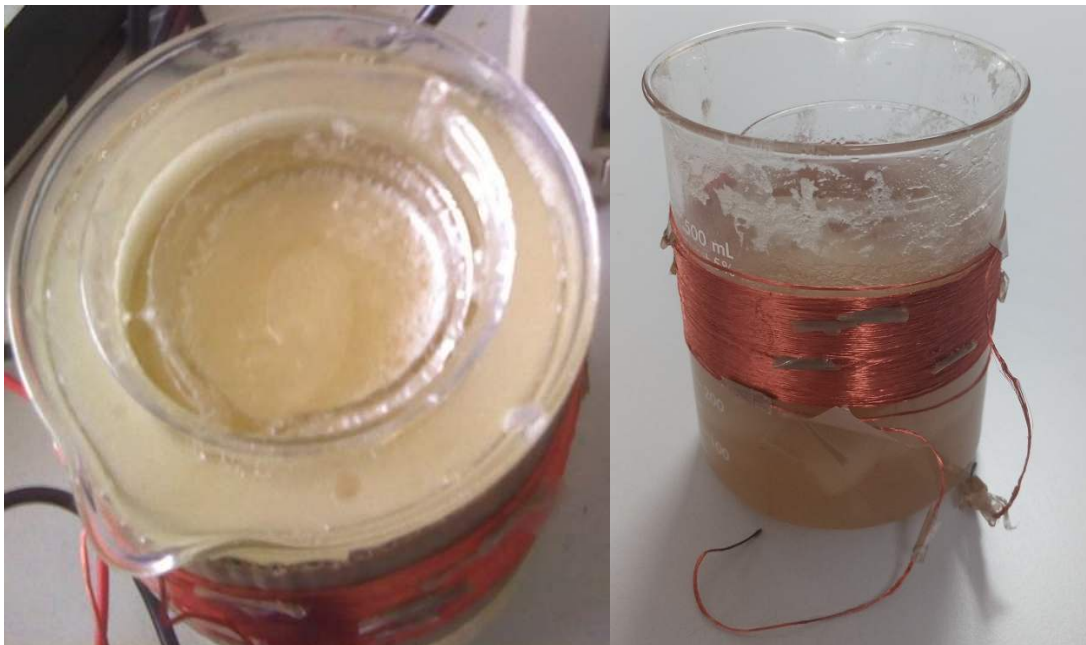
Figura 9. Fantasma multicapa emulando 4 densidades corporales humanas diferentes.
