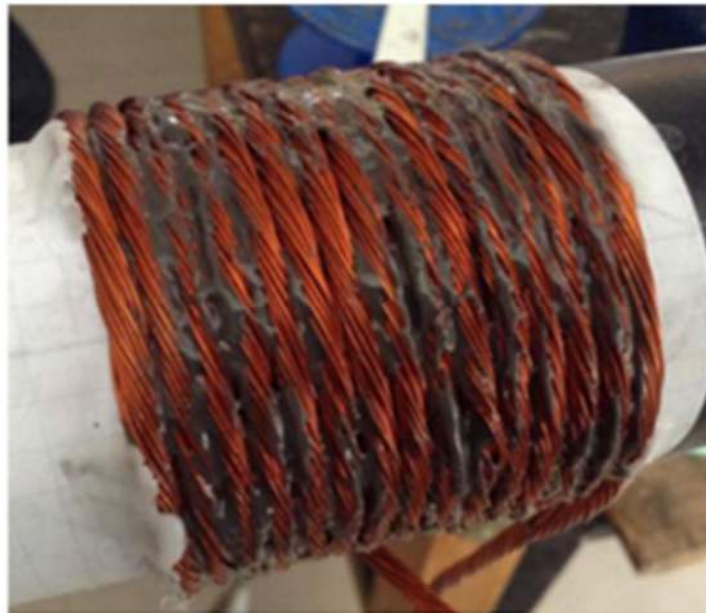
Figura 5. Inductor usado en [38]
