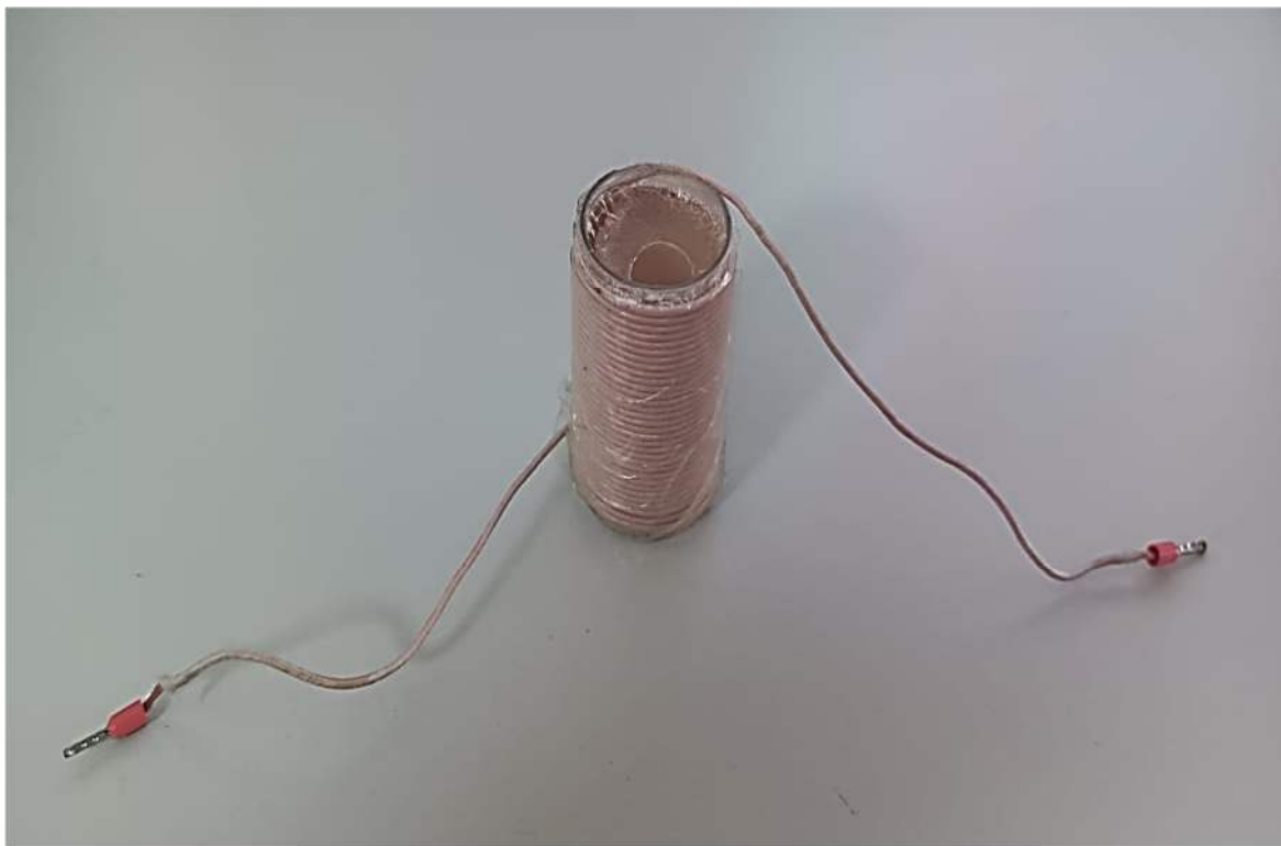
Figura 10. Fantasma con una sola densidad con el Inductor colocado.
