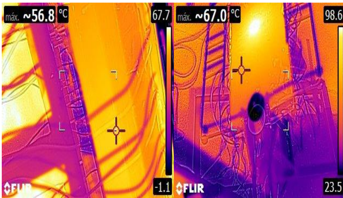
Figura. 58. Temperaturas en caras caliente y fría obtenidas en máximos valores en tercera prueba en serie.
