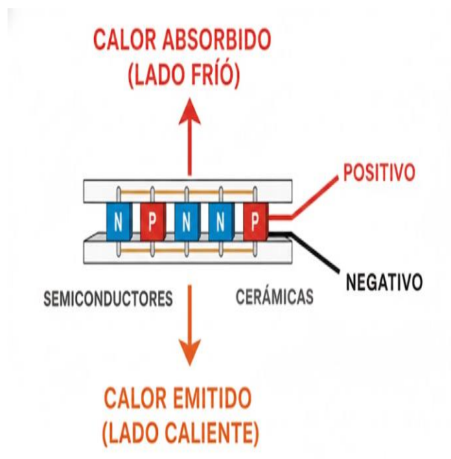
Figura. 7. Estructura de una celda Peltier.
