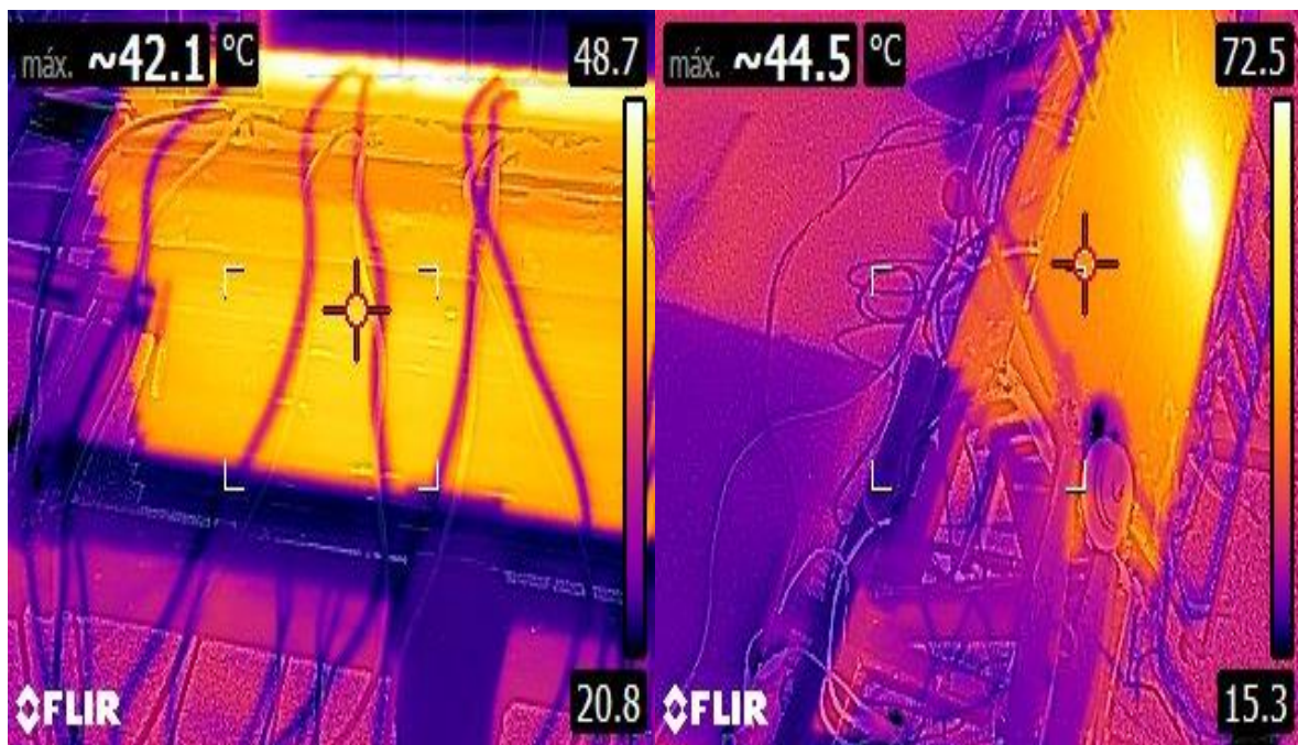
Figura. 86. Temperaturas en caras caliente y fría obtenidas en mínimos valores obtenidos en segunda prueba en paralelo.
