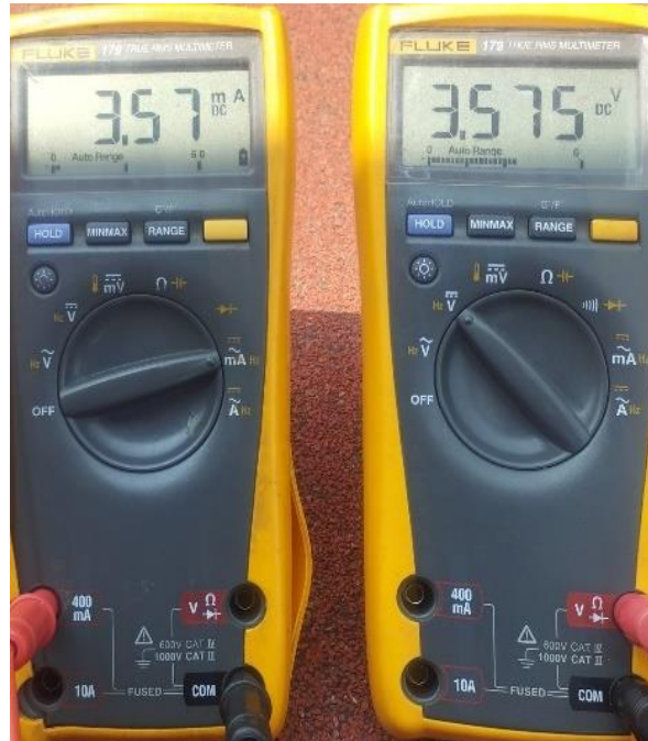
Figura. 49. Tensión y corriente máximas obtenida en segunda prueba en serie.
