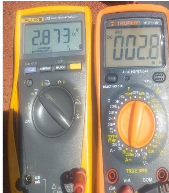
Figura. 41. Tensión y corriente máximas obtenida en primera prueba en serie.
