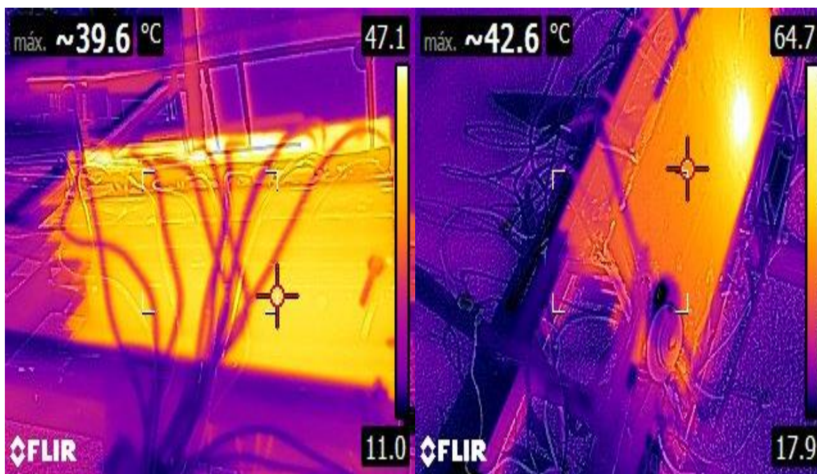
Figura. 95. Temperaturas en caras caliente y fría obtenidas en mínimos valores obtenidos en tercera prueba en paralelo.
