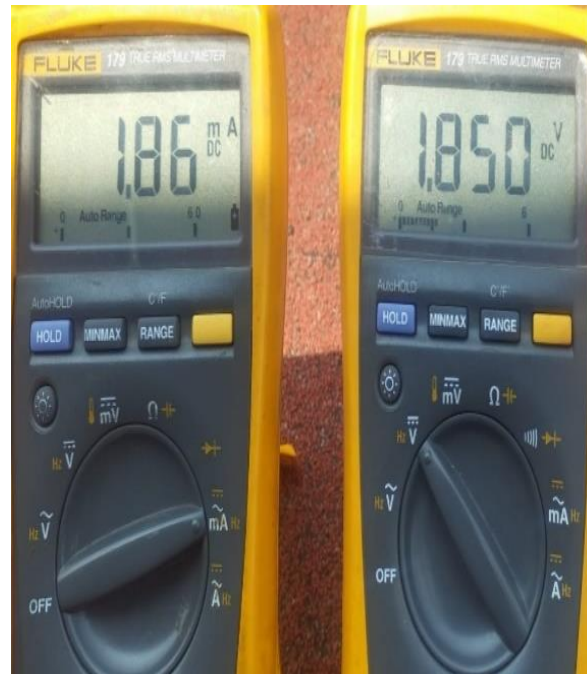
Figura. 81. Tensión y corriente máximas obtenida en segunda prueba en paralelo.
