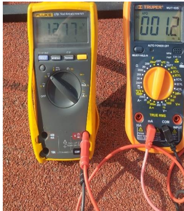
Figura. 45. Tensión y corriente mínimas obtenida en primera prueba en serie.
