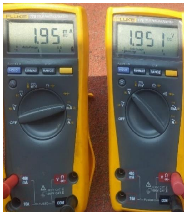
Figura. 90. Tensión y corriente máximas obtenida en tercera prueba en paralelo.
