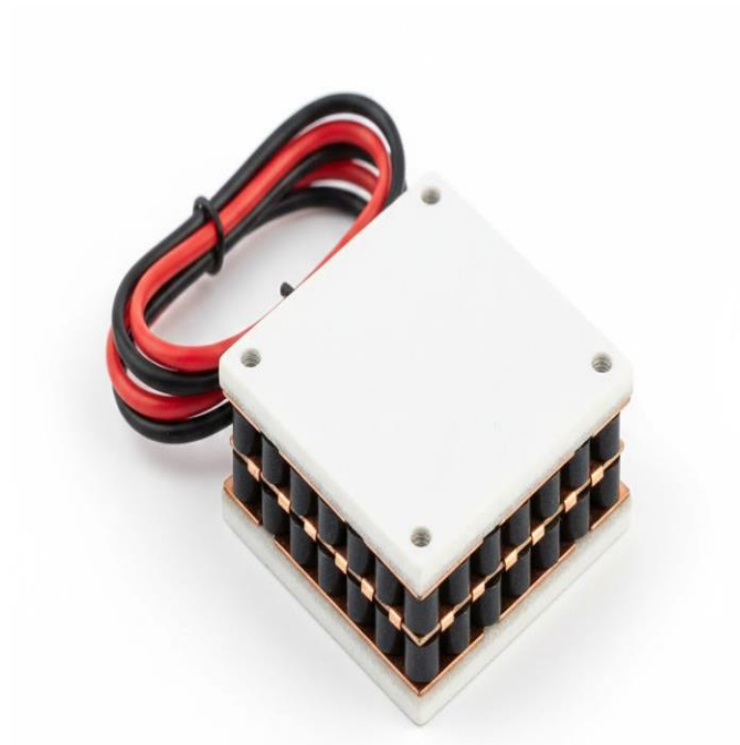
Figura. 6. Aspecto físico de una celda Peltier.
