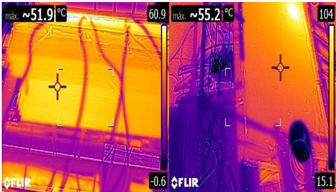
Figura. 62. Temperaturas en caras caliente y fría obtenidas en mínimos valores en tercera prueba en serie.
