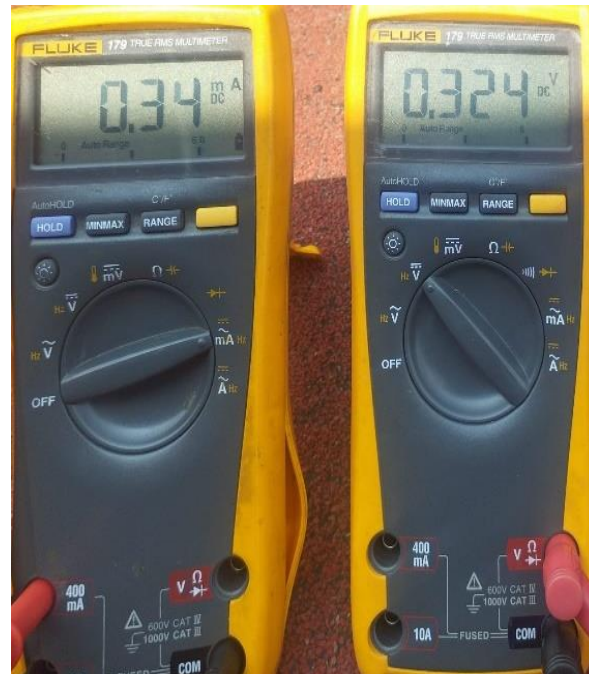
Figura. 85. Tensión y corriente mínimas obtenida en segunda prueba en paralelo.
