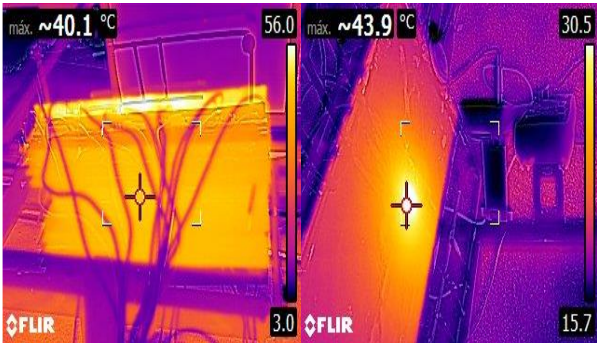
Figura. 77. Temperaturas en caras caliente y fría obtenidas en mínimos valores obtenidos en primera prueba en paralelo.
