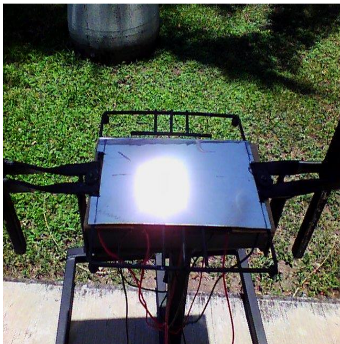
Figura. 15. Punto focal concentrado en placa de aluminio.
