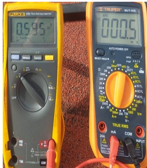
Figura. 76. Tensión y corriente mínimas obtenida en primera prueba en paralelo.
