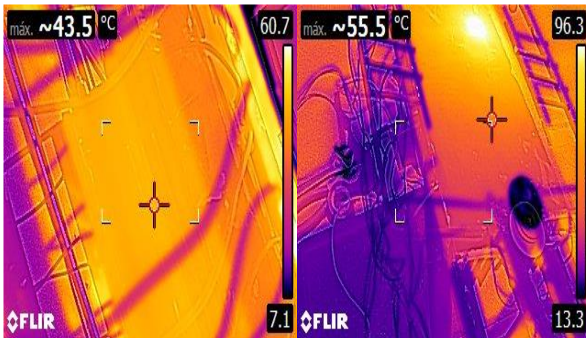
Figura. 82. Temperaturas en caras caliente y fría obtenidas en máximos valores obtenidos en segunda prueba en paralelo.
