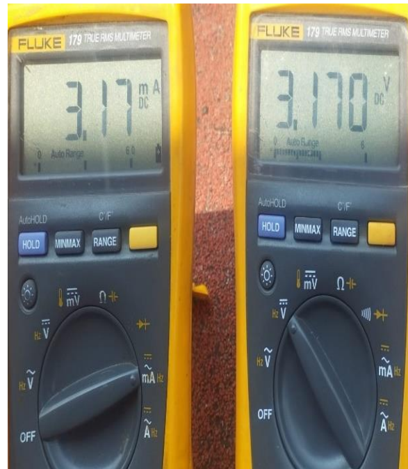
Figura. 57. Tensión y corriente máximas obtenida en tercera prueba en serie.
