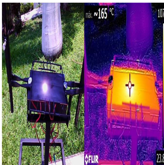
Figura. 17. Temperatura en punto focal de lámina de cobre pintada de negro.
