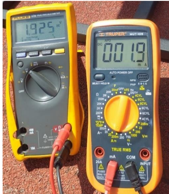
Figura. 72. Tensión y corriente máximas obtenida en primera prueba en paralelo.
