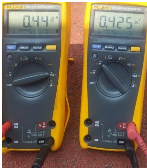
Figura. 94. Tensión y corriente mínimas obtenida en tercera prueba en paralelo.
