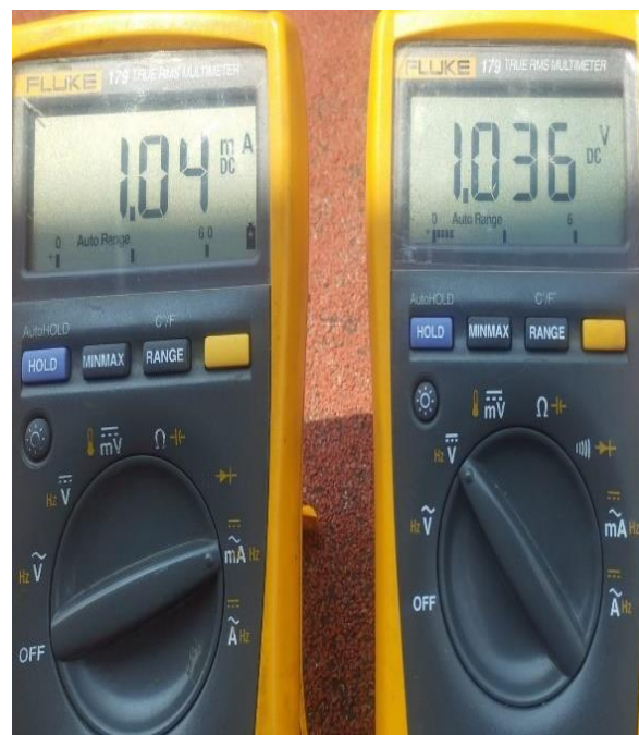
Figura. 61. Tensión y corriente mínimas obtenida en tercera prueba en serie.
