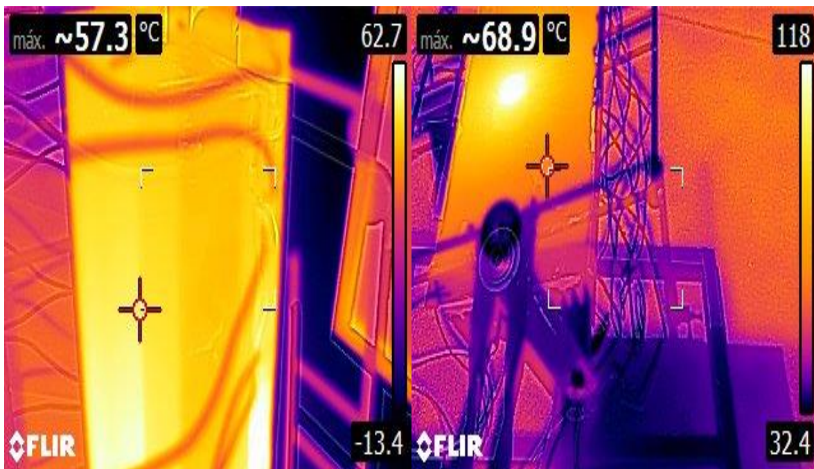
Figura. 50. Temperaturas en caras caliente y fría obtenidas en máximos valores en segunda prueba en serie.
