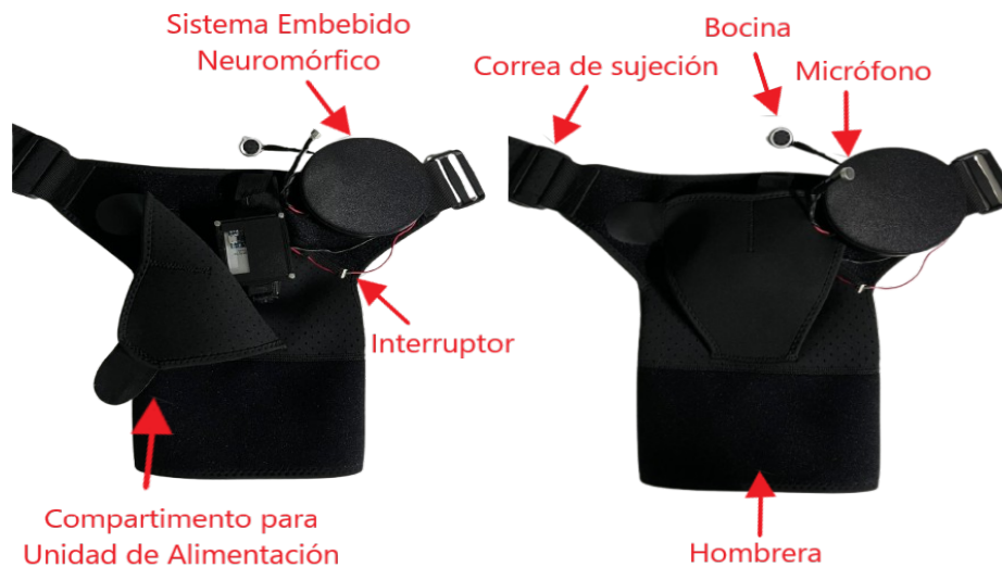
Figura 4.20: Integración del sistema neuromórfico en la prenda vestible (wearable) con sus partes.
