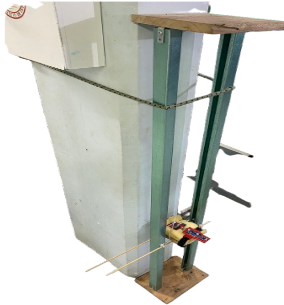
Figura 3.32: Esquema general de prueba experimental para configuración del sistema embebido de monitoreo inercial.
