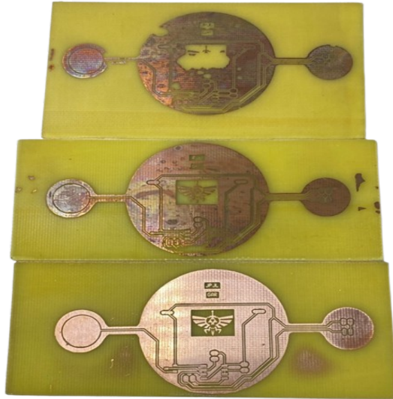
Figura 3.8: Pruebas de manufactura de tarjetas de circuito impreso de sensor capacitivo por descomensación de carga
