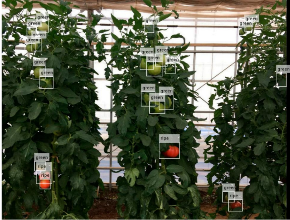
Figura 28: Cajas delimitadoras y etiquetas de clases generado por la red. Fuente: Madhavi et al. [32, Figura 18].
