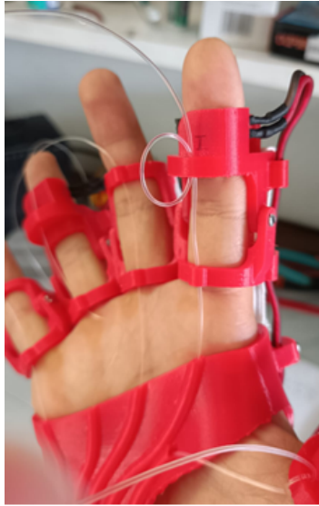
Figura 96: Amarrado de los sensores en los anillos de las falanges medias
