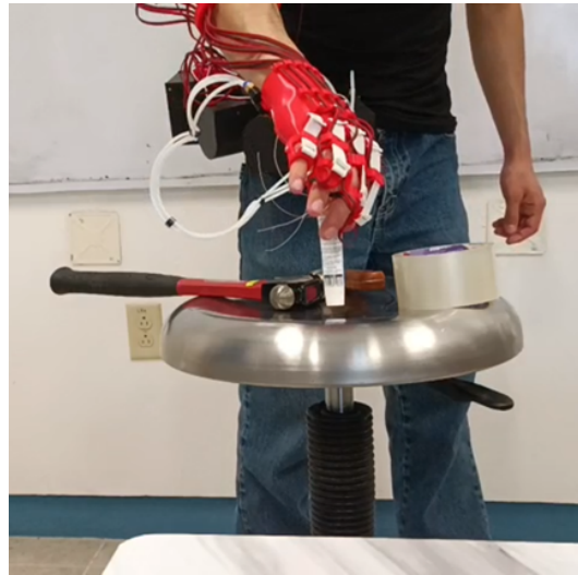
Figura 128: Prueba de two-point pinch con un tubo delgado
