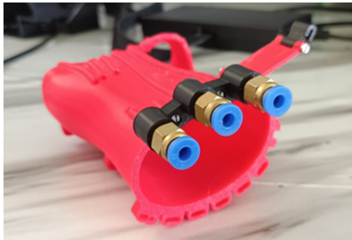
Figura 70: Acople con los conectores neumáticos Pc4-M6
