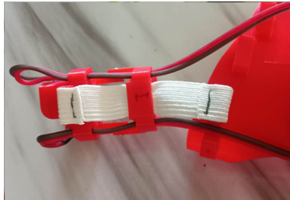
Figura 76: Elástico de ropa cosido por ambos extremos en el exoesqueleto
