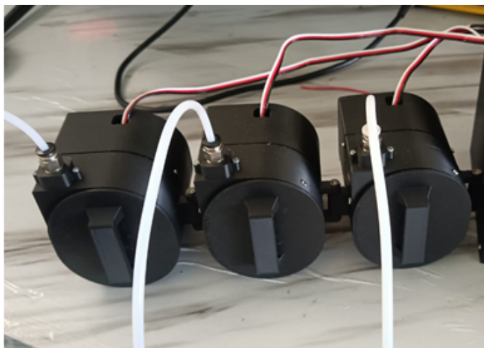
Figura 94: Tubos de PTFE puestos en los conectores Pc4-M10
