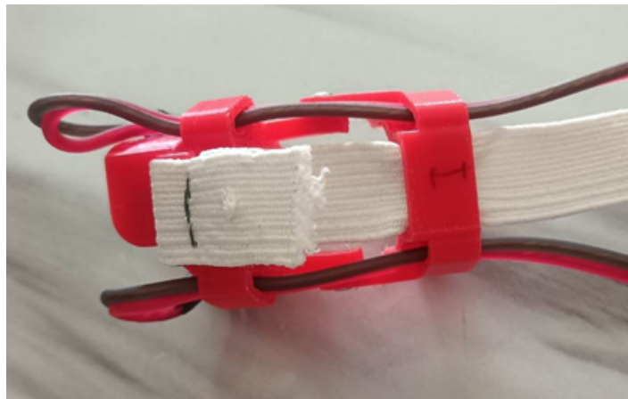
Figura 74: Anillos de las falanges del dedo índice con elástico para ropa
