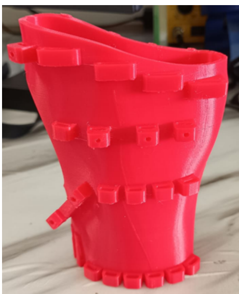
Figura 68: Estructura de la parte palmar elaborado con filamento TPU
