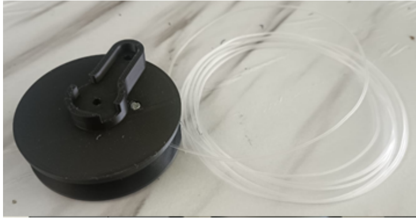
Figura 61: Rueda con hilo de nylon de 0.9mm
