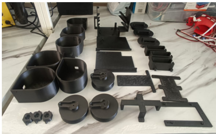
Figura 57: Piezas impresas con filamento PLA+ para el ensamblado de los servomotores
