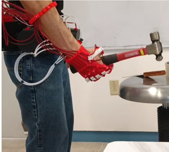
Figura 126: Prueba de power grip con un martillo
