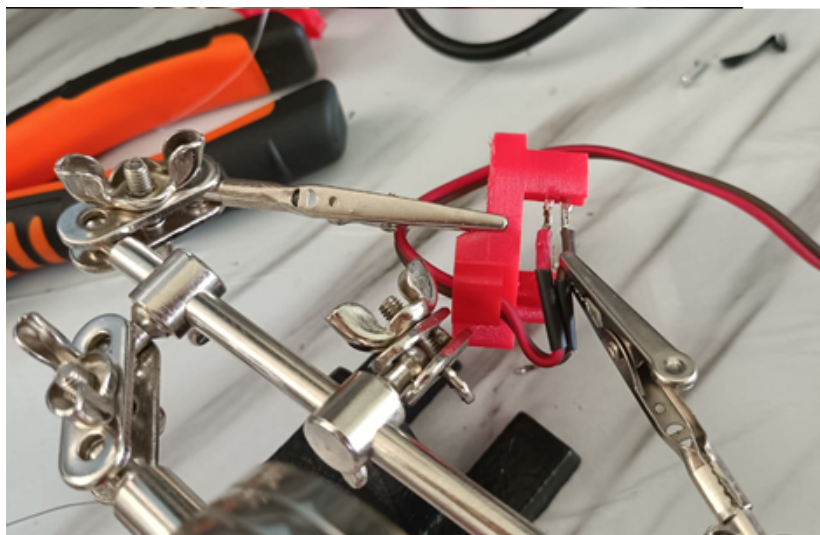
Figura 72: Soldado de cables dúplex con los sensores de fuerza
