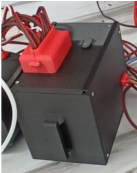
Figura 93: Tapas deslizables con sello de TPU
