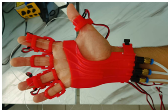
Figura 95: Tubos de PTFE colocados en los conectores neumáticos Pc4-M6
