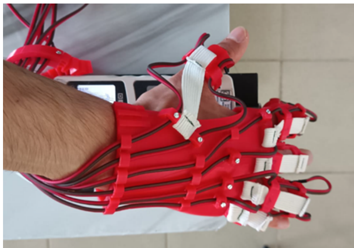
Figura 118: Medición de fuerza del servomotor del dedo índice
