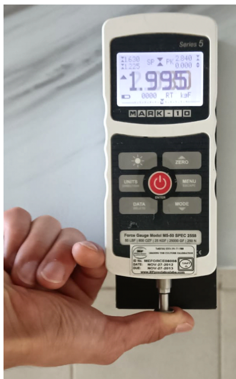
Figura 120: Medición de fuerza del dedo pulgar
