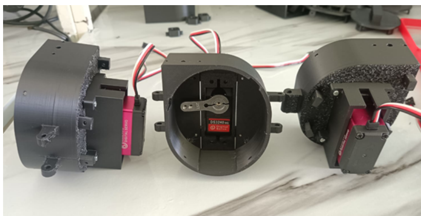
Figura 59: Servomotores colocados en la base principal
