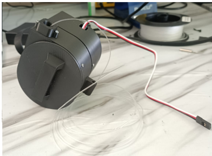
Figura 66: Carcasa con acople para conector neumático
