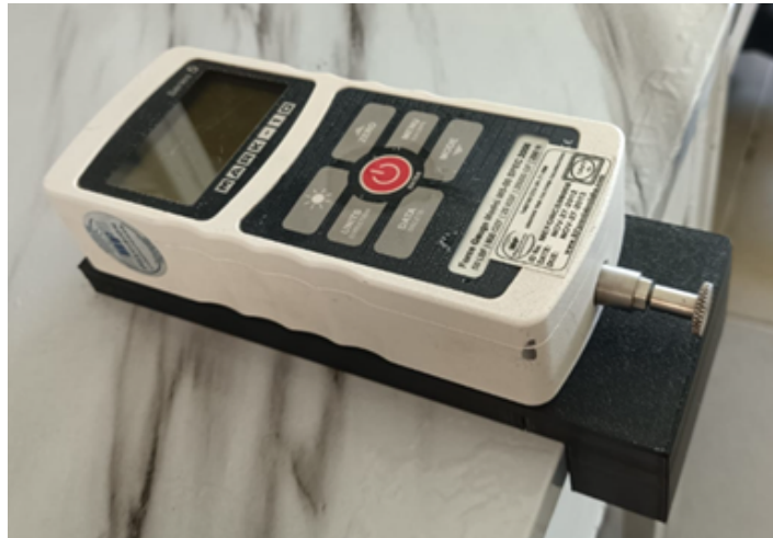
Figura 117: Dinamómetro con base impresa en filamento PLA
