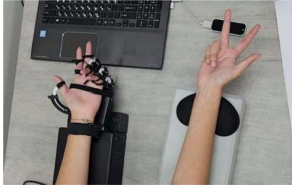
Figura 18: Control del Exoesqueleto mediante Leap Motion
