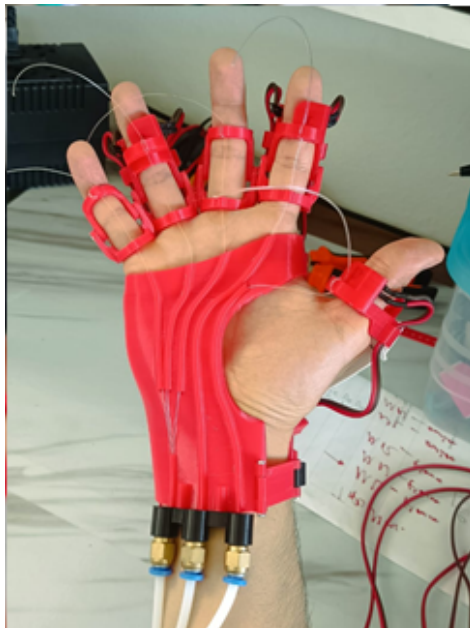
Figura 97: Hilos del exoesqueleto amarrados en su lugar
