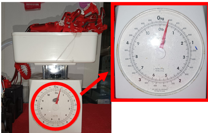
Figura 116: Pesaje de exoesqueleto (solo estructura mecánica)
