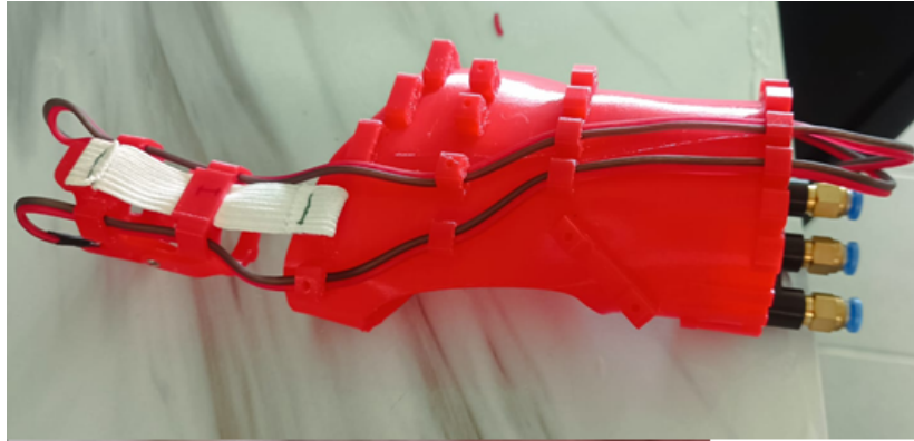
Figura 77: Cables introducidos en la parte dorsal de la estructura palmar
