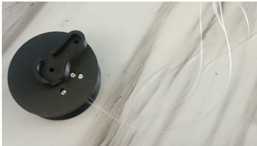
Figura 62: Rueda de 3 canales con hilos de nylon de 0.5mm
