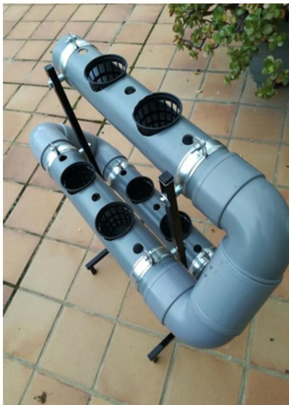
Figura 18: Estructura del cultivo hidropónico.
