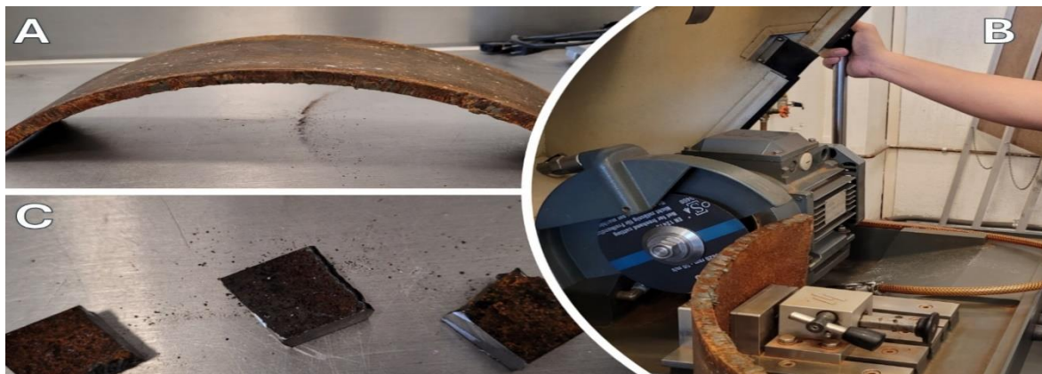
Ilustración 6 A) Segmento STD obtenido, B) Corte del STD para muestreo, C) Muestras obtenidas del corte Fuente: (Elaboración propia).
