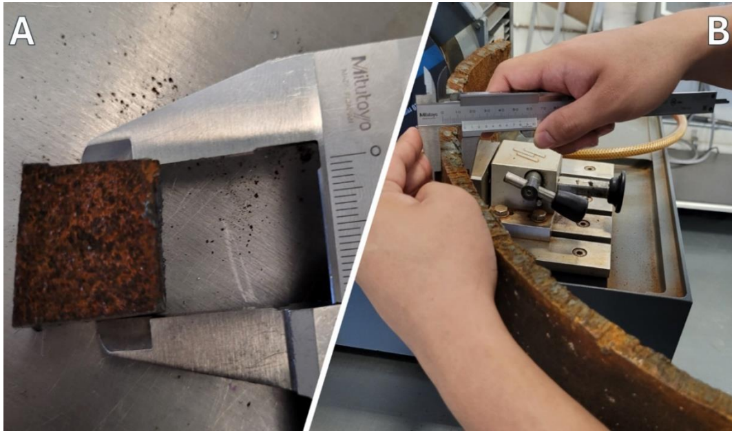
Ilustración 7 A) Medición de las muestras obtenidas, B) Medición del grosor del STD obtenido Fuente: (Elaboración propia).
