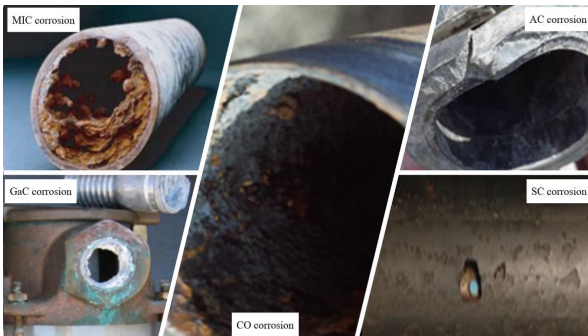
Ilustración 1 SC (Corrosión dulce), AC (Corrosión ácida), CO (Corrosión por oxígeno), GaC (corrosión galvánica) y MIC (corrosión microbológica) (Fuente: (Pérez 2013, Popoola et al. 2013)).
