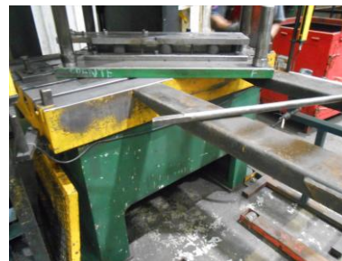
Figura 3.39. Altura de las uñas del elevador (a) a nivel del troquel móvil (b) a nivel del troquel fijo. (fuente: elaboración propia).
