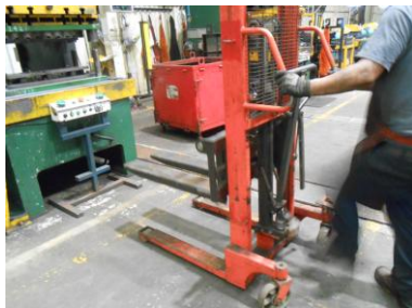
Figura 3.38. Sistema de accionamiento de elevador (a) accionamiento por pedal (b) accionamiento por palanca. (fuente: elaboración propia).
