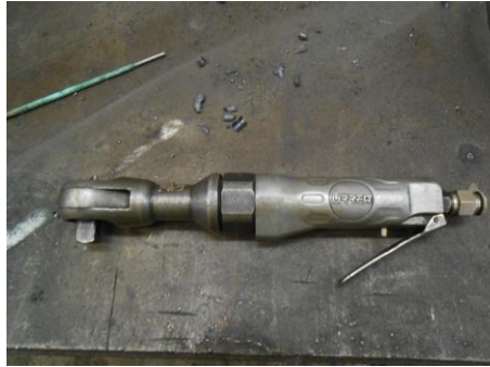
Figura 3.37. Desatornillador neumático para aflojar la tornillería. (fuente: elaboración propia).
