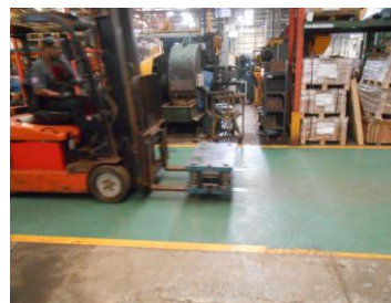
Figura 3.45. Traslado de troquel al área de prensas. (fuente: elaboración propia).
