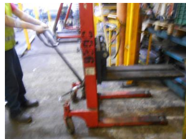
Figura 3.38. Sistema de accionamiento de elevador (a) accionamiento por pedal (b) accionamiento por palanca. (fuente: elaboración propia).
