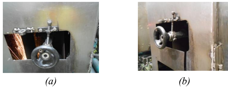
Figura 3.32. Seguro de fijación de manubrio (a) vista frontal (b) vista frontal/derecha. (fuente: elaboración propia).
