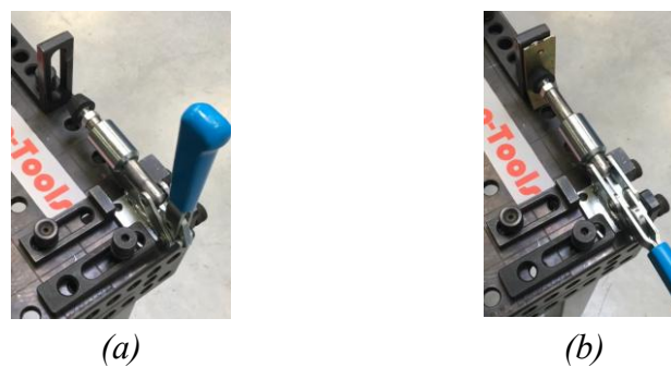
Figura 3.33. Propuesta de nuevo sistema de fijación (a) apertura, (b) cierre. (fuente: elaboración propia).
