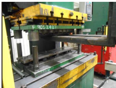
Figura 3.39. Altura de las uñas del elevador (a) a nivel del troquel móvil (b) a nivel del troquel fijo. (fuente: elaboración propia).
