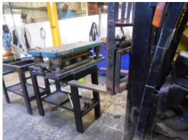
Figura 3.44. Carga de troquel mediante montacargas. (fuente: elaboración propia).
