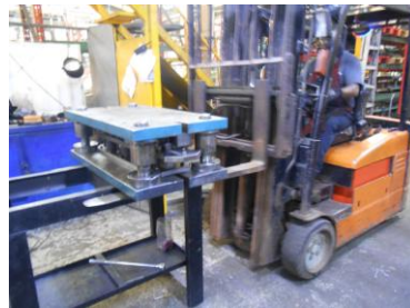
Figura 3.44. Carga de troquel mediante montacargas. (fuente: elaboración propia).
