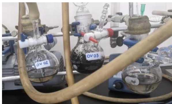
Figura 4.6. Lavado con n -pentano de los materiales.
