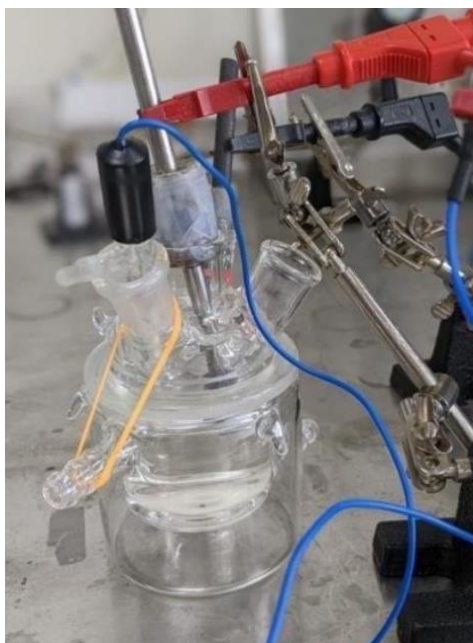
Figura 4.2. Foto de celda electroquímica
