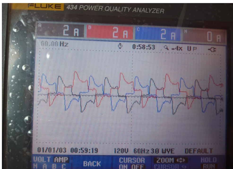
Figura 6.2: Formas de onda de corriente capturadas por el Fluke 434.
