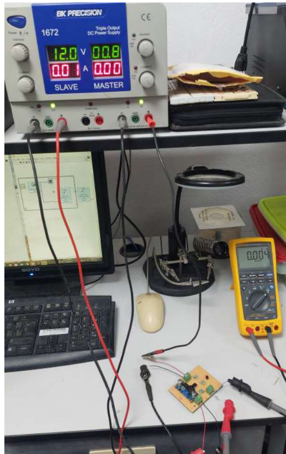
Figura 5.2: Fuente de corriente constante manteniendo 4 mA de salida
