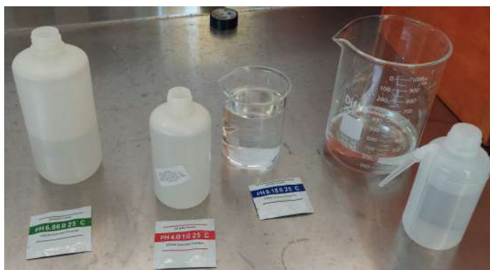
Figura 4.31: Soluciones buffer para la calibración del sensor de pH
