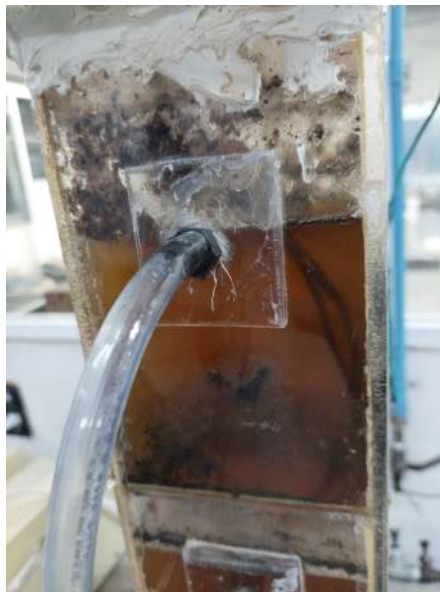
Figura 4.14: Nivel del agua residual dentro a la salida del efluente del reactor
