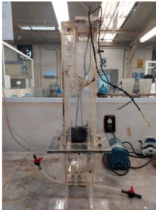
Figura 4.2: Fotografía de un Reactor Anaerobio de Flujo Ascendente electroquímico
