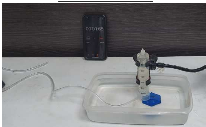
Figura 5.4: Prueba de desplazamiento de gas durante un minuto
