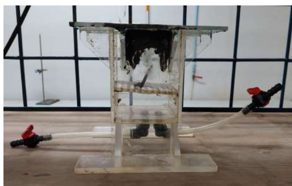
Figura 4.6: Conexión de válvulas y mangueras de entrada y recirculación
