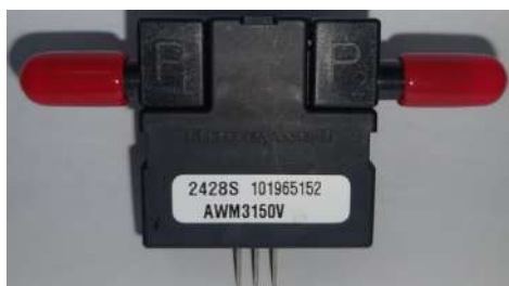
Figura 4.15: Sensor de microflujo de biogás AWM 3150V
