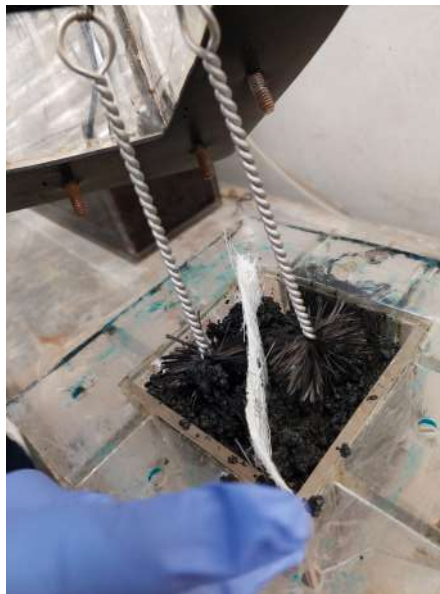
Figura 4.7: Inoculación del reactor
