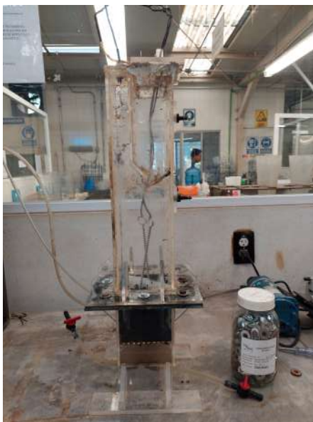
Figura 4.9: Reactor UASB electroquímico inoculado y cerrado
