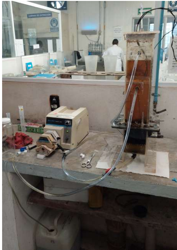
Figura 4.12: Conexiones del reactor UASB electroquímico
