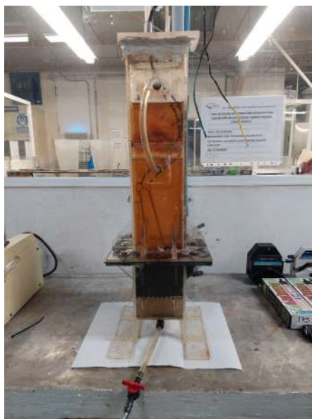
Figura 4.11: Llenado del reactor UASB electroquímico con vinaza
