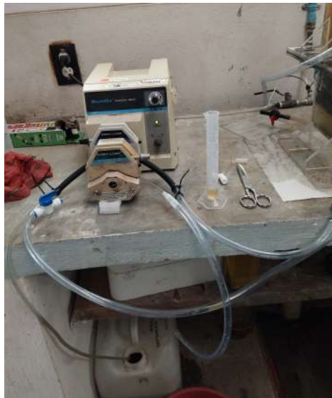
Figura 4.13: Aforo del caudal del reactor
