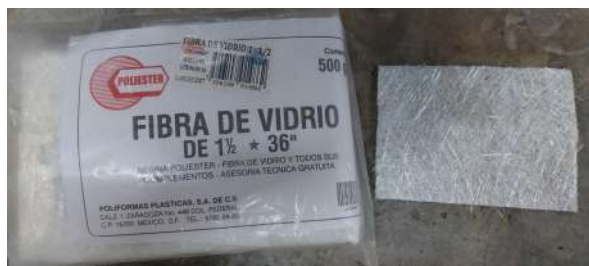
Figura 4.4: Sección de fibra de vidrio
