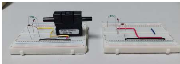
Figura 4.24: Fuente de alimentación para el sensor de biogás realizada en protoboard
