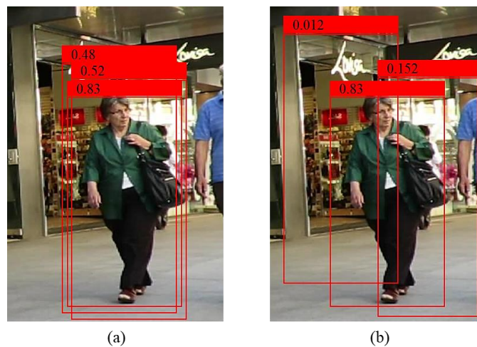
Figura 5.4. Ejemplo de detecciones redundantes alineadas (a) y no alineadas (b).
