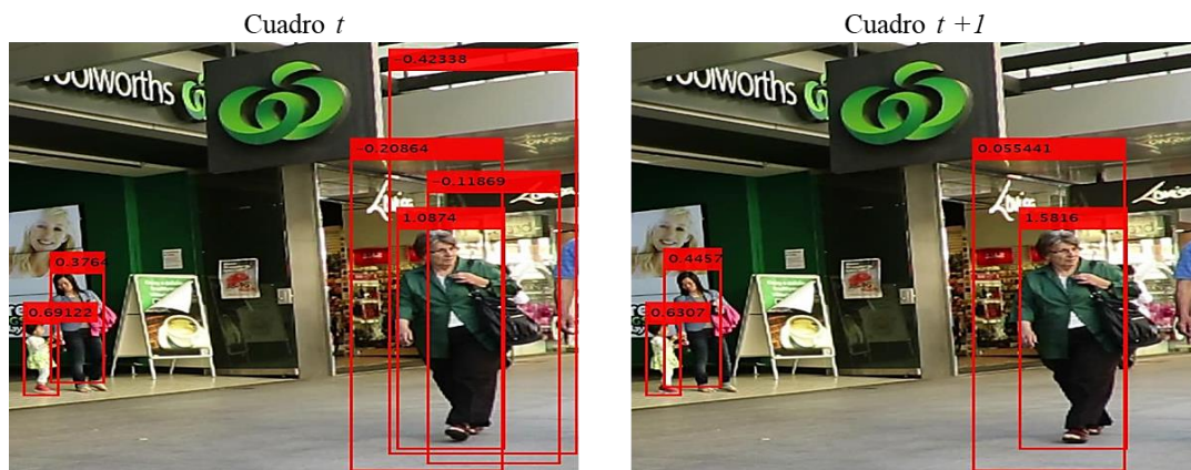
Figura 5.3. Ejemplo de detecciones proporcionadas por un detector en dos cuadros de video consecutivos.
