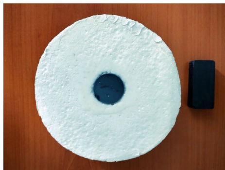
Figura 7.18. Vista posterior del objeto bajo prueba con un imán incrustado.
