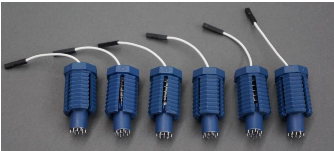
Figura 2.6. Electrodo secos del sistema de adquisición OpenBCI® [55].
