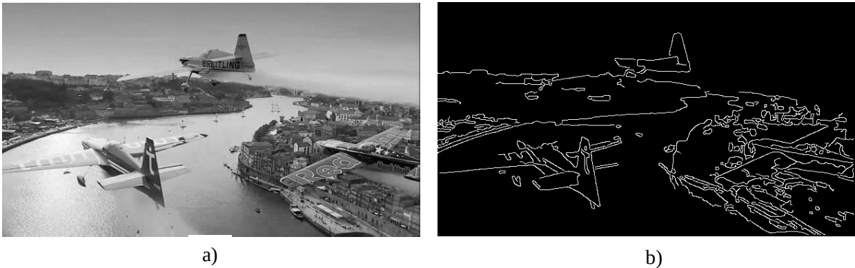
Figura 2.14. a) Cuadro de luminancia I_L^t(x, y) , b) Imagen de bordes I_{LB}^t(x, y) del cuadro de luminancia.
