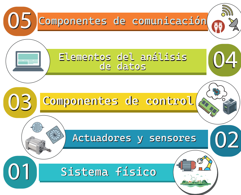
Fig. 3.2. Arquitectura de los sistemas ciberfísicos.
