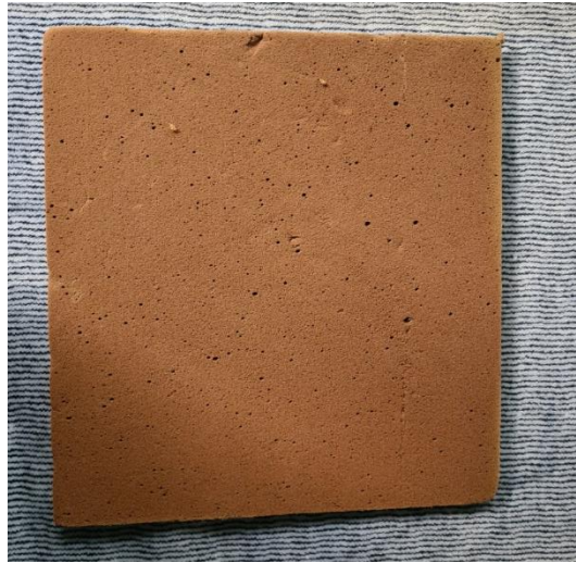
Figura 4.2. Sustrato: espuma fenólica.
