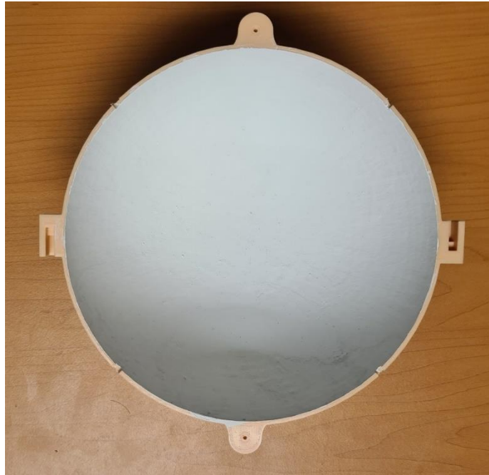
Figura 5.4. Recubrimiento interno del hemisferio impreso.
