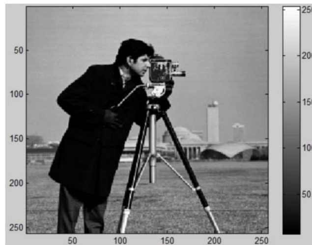
Figura 3.3. Representación de una imagen en escala de grises de 8 bits [20].
