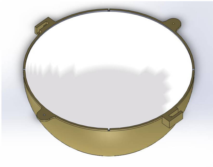
Figura 5.3. Diseño del hemisferio, vista inferior.
