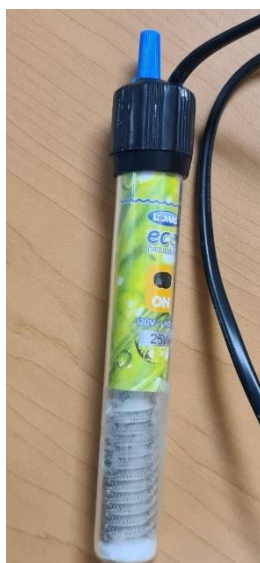
Figura 4.7. Termostato eléctrico utilizado en el ajuste de temperatura del recipiente.
