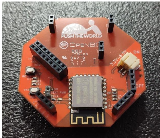
Figura 2.2. Módulo OpenBCI WiFi Shield.
