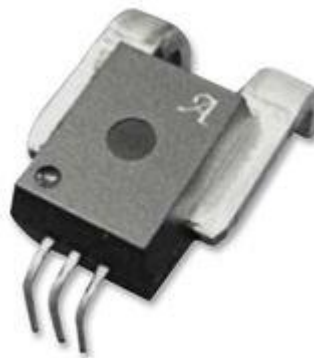
Figura 4.10. Sensor de efecto hall integrado para la medición de corriente eléctrica.
