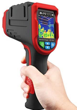
Figura 4.8. Cámara infrarroja para medición de temperatura.
