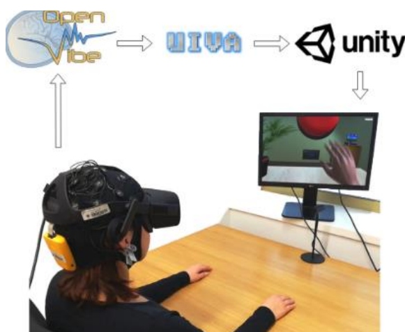
Figura 2.4 Sistema de entrenamiento con base en VR implementado en [8].
