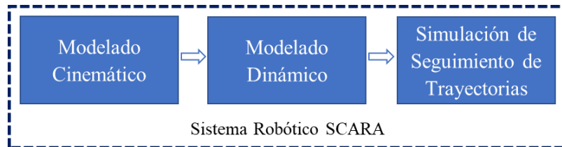
Figura 4.23. Metodología del diseño de un robot SCARA.
