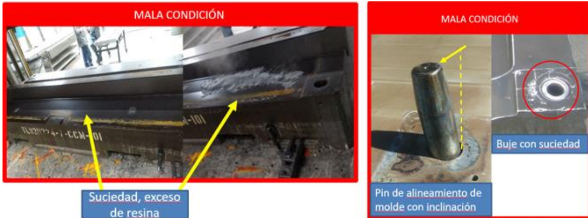
Figura 30.24 Molde en mala condicion EZAir.
