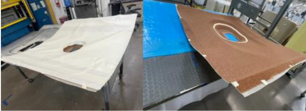
Figura 23.17 Colocación de capas de materiales en EZAir.
