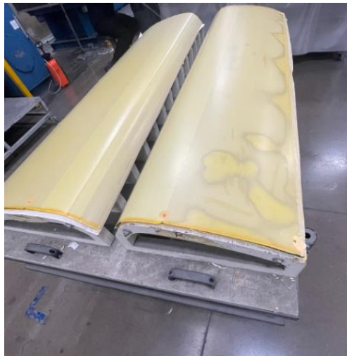
Figura 24.18 Colocación de pieza en fixtura de enfriamiento en EZAir.
