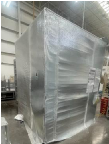
Figura 58.15 Horno fabricado de materiales económicos para calentamiento de moldes en EZAir.
