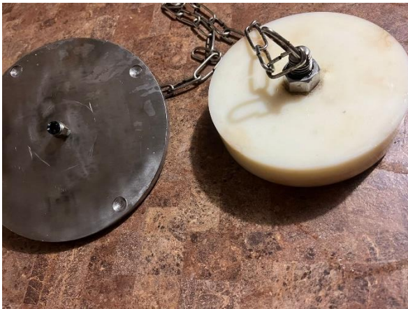
Figura 36. Émbolo encargado de empujar la masa.
