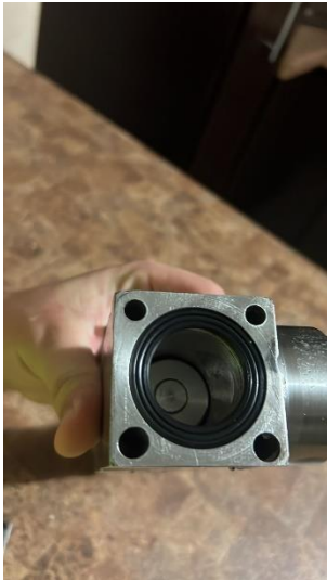
Figura 39. Sellos colocados en bloque de obstrucción.
