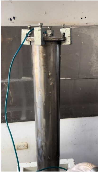
Figura 35. Cilindro de alimentación.
