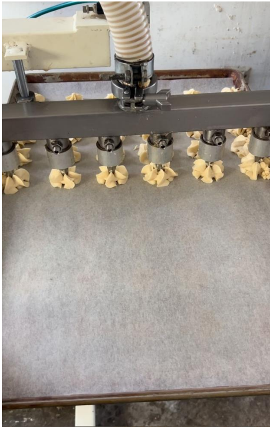
Figura 41. Máquina de galletas pastisetas en funcionamiento.
