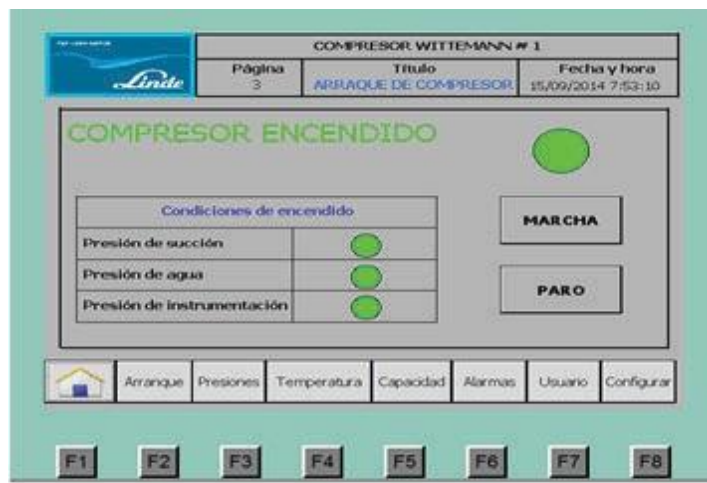
Figura 3.17 Pantalla de arranque de compresor
