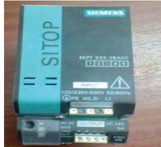
Figura 2.17 Fuente de voltaje de 24VDC
