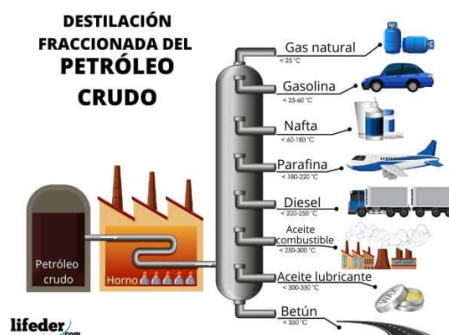
Figura 2.1 Destilación fraccionada del petróleo crudo (Lifeder, 2022).
